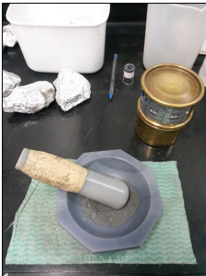
Figura 26 - Materiais utilizados para maceração das amostras para posterior análise de COT e Pirólise Rock-Eval.
