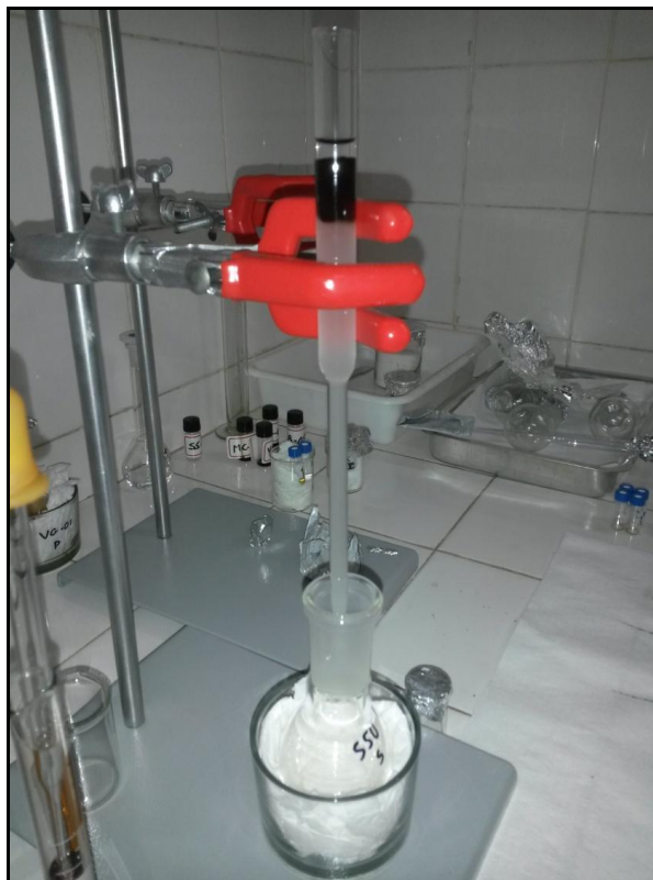
Figura 29 - Fracionamento do betume por cromatografia líquida em coluna de sílica.
