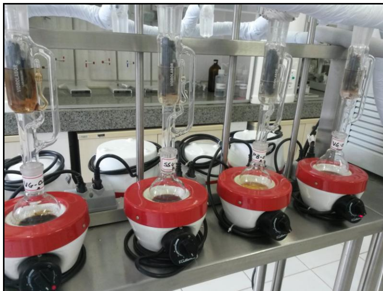
Figura 28 - Extração dos betumes utilizando extrator Soxhlet.
