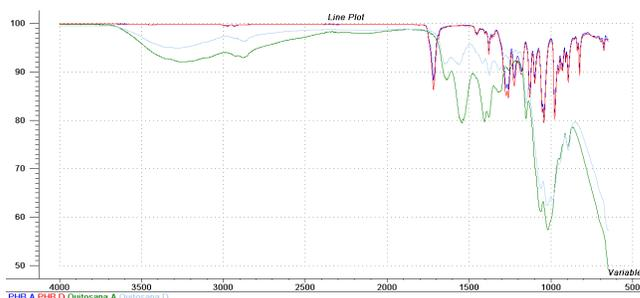
Figura 1: Espectro na região do infravermelho do PHB antes (A) e depois (D) da esterilização térmica e da quitosana antes (A) e depois (D) da esterilização térmica.
