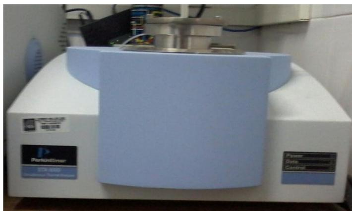
**Figura 23** - Termobalança Perkin Elmer, modelo STA 6000.
