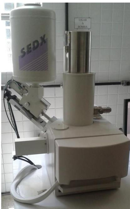
**Figura 21** - Microscópio Eletrônico de Varredura Shimadzu SS-550 Superscan.
