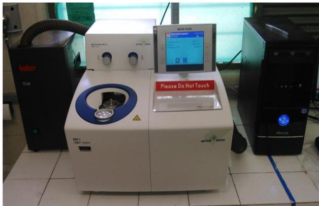
**Figura 24** - Equipamento DSC 1 STAR<sup>o</sup> SYSTEM.
