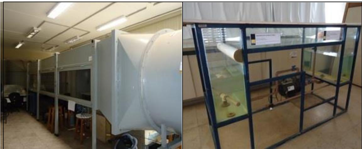
**Figura 33:**a) Túnel de vento do laboratório de conforto ambiental da Universidade Estadual de Campinas, b) Mesa d'água do laboratório GECA da Universidade Federal de Alagoas. **Fonte:** Arquivo Pessoal.
