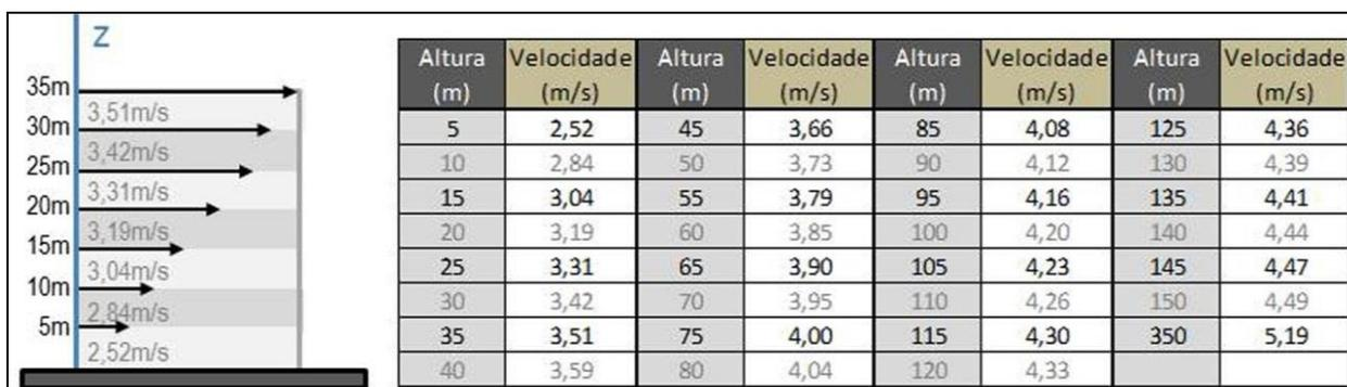
**Figura 59:** Esquema de gradiente de ventilação e tabela de velocidade do vento Sul. **Fonte:** Elaboração própria
