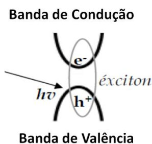
Figura 6 - Esquema de formação de um éxciton . No qual, h^+ representa o buraco gerado na banda de valência, pela excitação do elétron e^- , h\nu a energia de um fóton excitando a amostra, E = h\nu , h é a constante de Planck e \nu é a frequência da luz.
