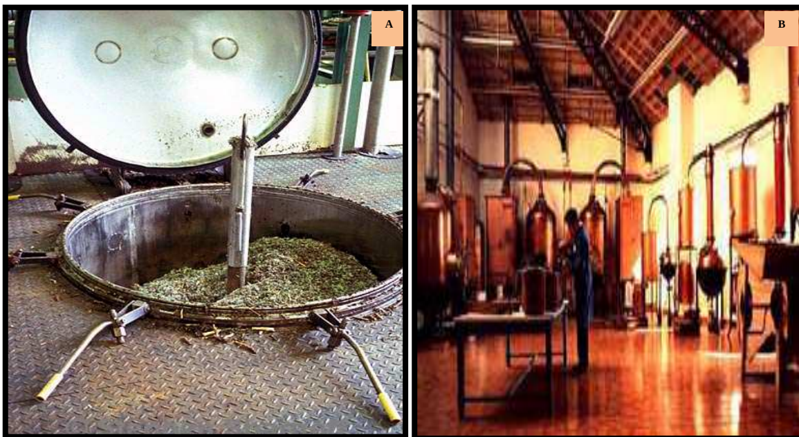
Figura 18 - Extrator (A) e destiladores (B) para obtenção de óleos e fixadores de perfumes obtidos dos líquens.
