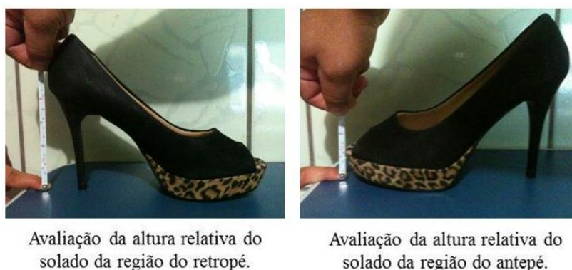
Figuras 1: Avaliação da altura do solado da região do antepé e do retropé (altura relativa do salto) pelo traçador de altura.
