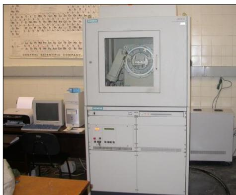
Figura 3.11 – Difratômetro de raios-x (Siemens, D 5000).
