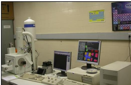
Figura 3.14 – Microscópio eletrônico de varredura (Jeol, JSM 6460).
