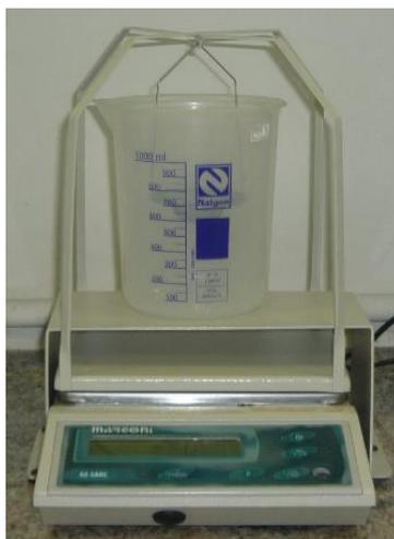
Figura 3.13 – Balança com dispositivo hidrostático (Marconi, AS 500C).
