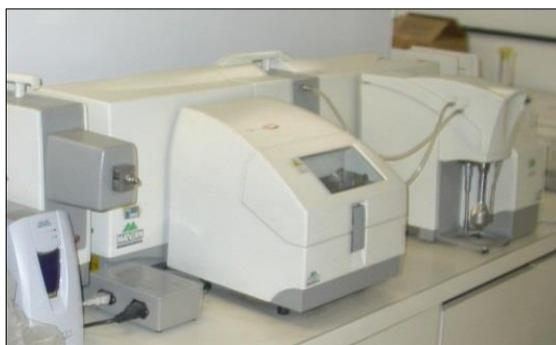
Figura 3.9 – Analisador granulométrico a laser (Malvern, Mastersizer 2000).
