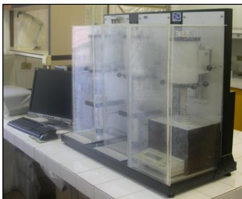
Figura 3.10 – Aparelho termoanalítico (BP Engenharia, RB 3000-20).
