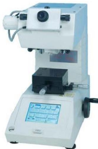
Figura 3.12 – Microdurômetro Vickers (Shimadzu, HMV-2).
