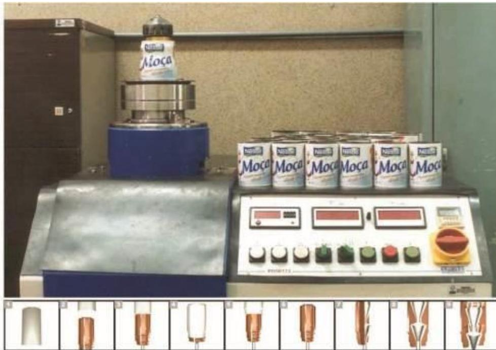
**Figura 78 – Máquina de Expansão de Protótipos.** Fonte: ESTOL, 2009, p. 56
