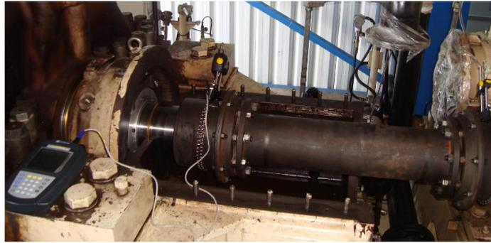
Figura 3.29 - Alinhamento a laser, turbogerador de 22MW.
