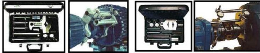
Figura 3.21 - Dispositivos de alinhamento com relógios comparadores ( A-Line Manufacturing's).
