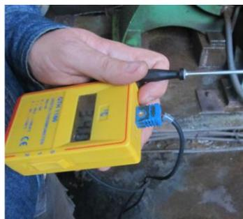
Figura 4.9 - Termômetro de contato GTH 1160.
