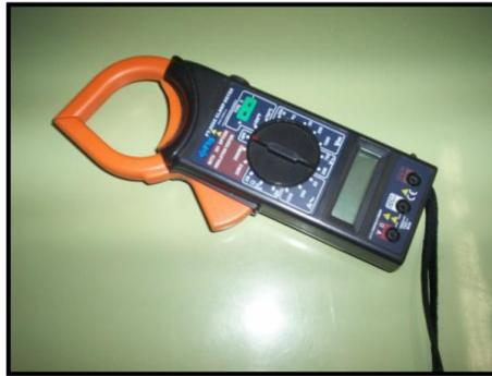
Figura A 3.2 - Alicate amperímetro.
