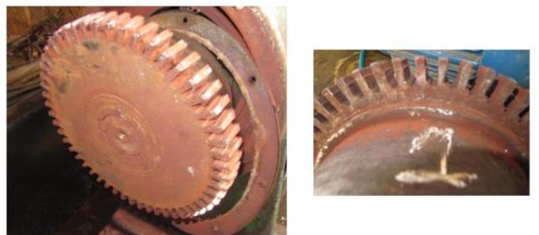
Figura 3.49 - Acoplamento de grade danificado por desalinhamento .
