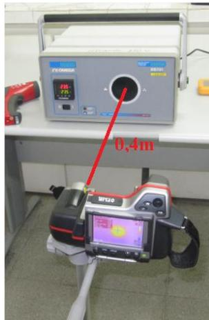
Figura 4.26 - Aparato para aferição da câmera termográfica .
