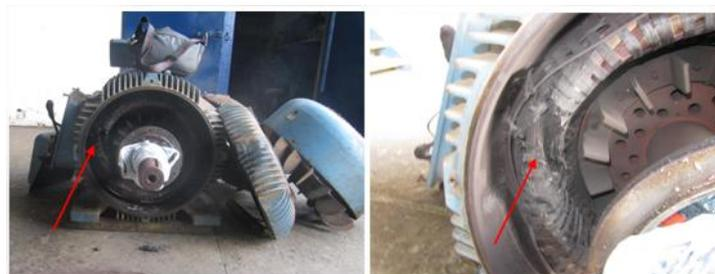
Figura 5.35 - Motor elétrico, queimado por desalinhamento.
