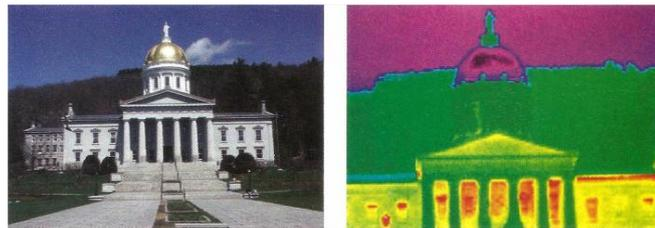
Figura 3.12 - Fachada de prédio com fuga de calor. Fluke -Technical Publishers, (2009).
