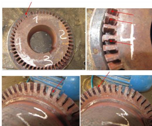
Figura 5.34 - Acoplamento danificado por desalinhamento .
