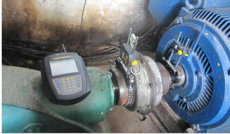
Figura 1.2-Alinhador a laser instalado em conjunto de motor e bomba.
