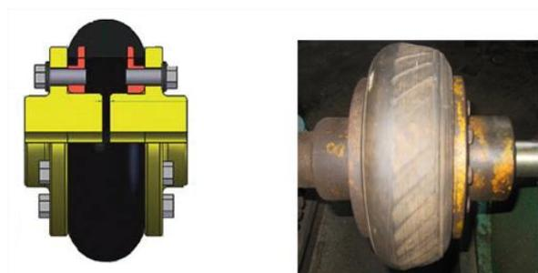
Figura 3.43 - Acoplamento Antares Mod. AT 90.
