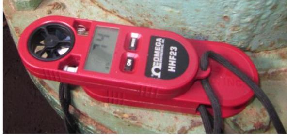
Figura A 3.1 - Anemômetro Omega tipo HHF23.
