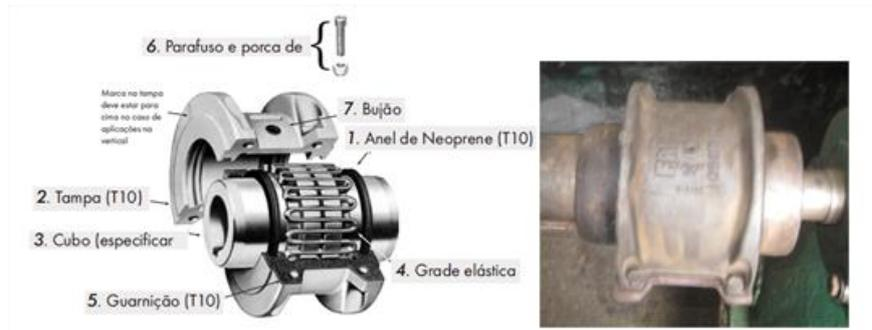
Figura 3.41 - Acoplamento Falk Mod. 1090 T.
