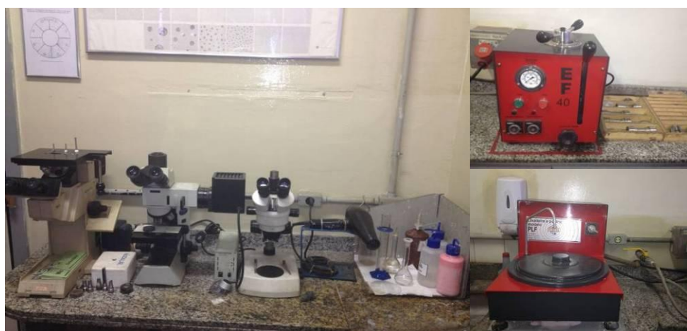
Figura-60. Fotos do Laboratório Metalúrgico da Simisa, microscópios, embutidora e lixadeira politriz ,2013
