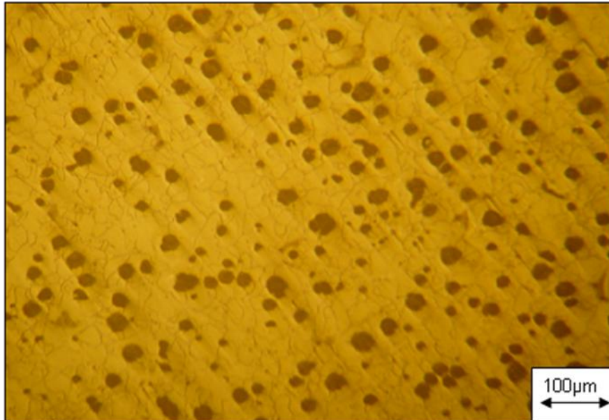
Fig.-63. Metalografia, ferro fundido nodular ferrítico da Corrida#3, ampliação 100X, reagente nital(2%).
