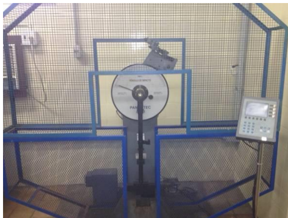
Figura-59. Foto da máquina de impacto do Laboratório da Simisa ,2013
