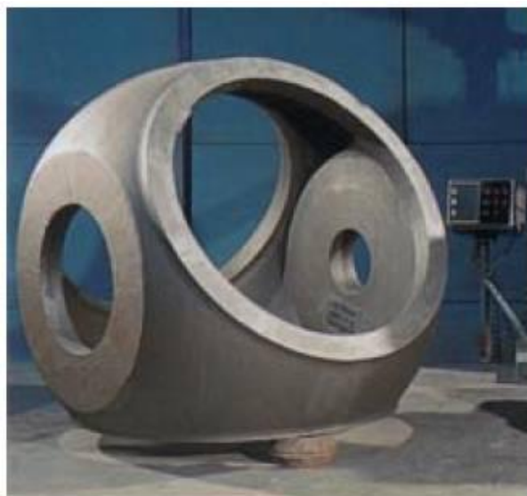
Fig.-19. Foto de um Cubo (HUB) de uma turbina eólica, Keith Millis Symposium on Ductile Cast Iron, 2003
