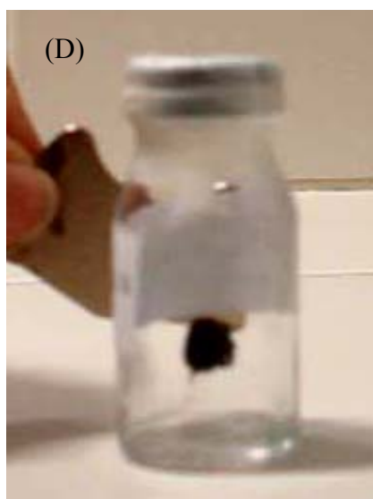
Figura 3.9: Fotografias da amostra GEM80 (A) antes e (B), (C) e (D) durante a interação com o campo magnético.
