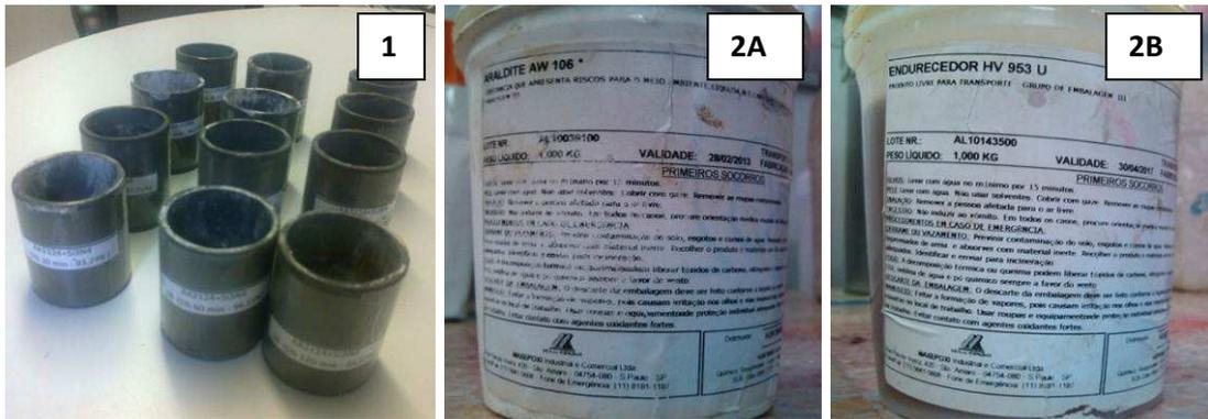
Figura 3.8 – Cilindros para embutimento das amostras (1) e resina e endurecedor utilizados para embutimento (2A e 2B).
