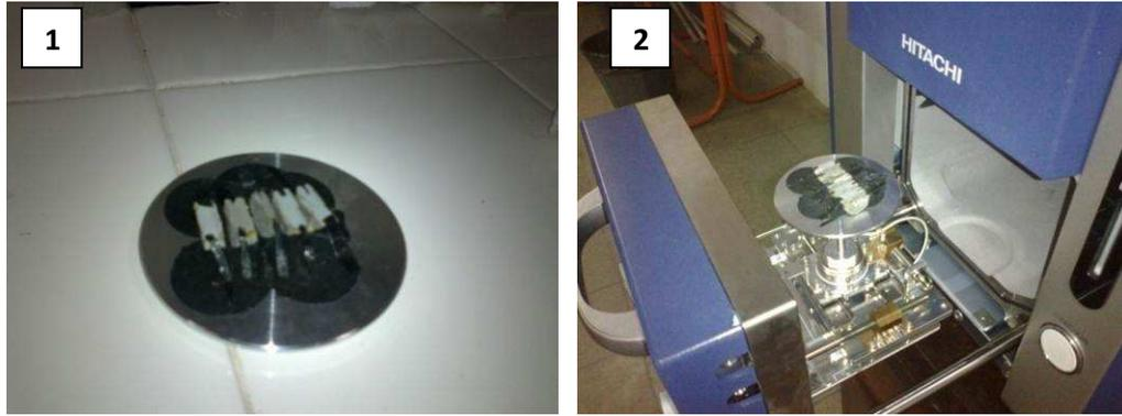
Figura 3.12 – Preparação das amostras (1); Colocação das amostras para análise (2).
