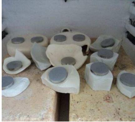
Figura 3.6 – Distribuição das pastilhas no forno para sinterização.
