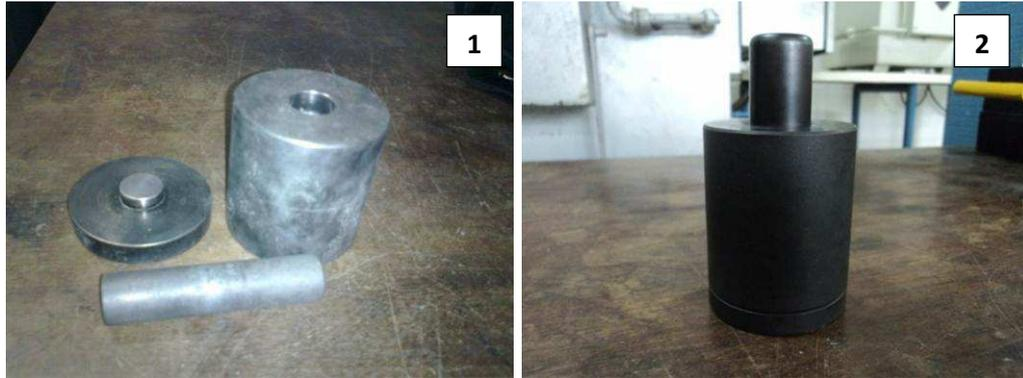
Figura 3.5 – Matriz de compactação desmontada (1) e matriz de compactação montada (2).
