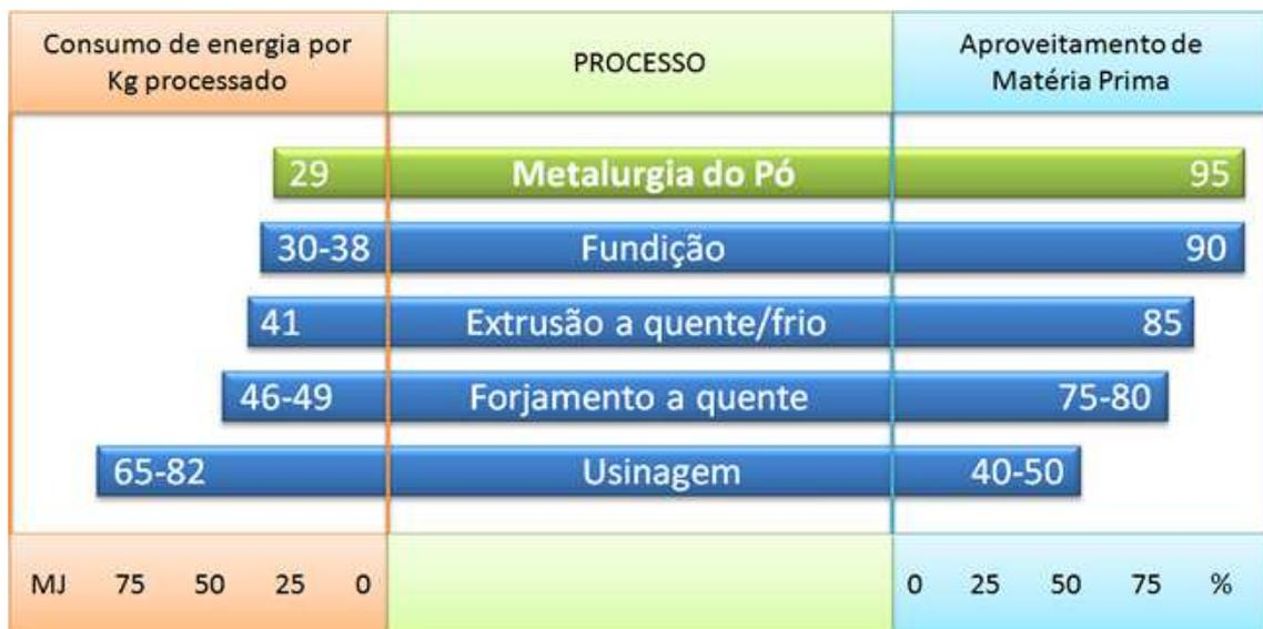
Figura 2.7 – Comparativo entre a técnica de metalurgia do pó e outros processos de fabricação (Associação Brasileira do Alumínio, 2013).
