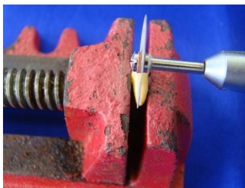
Figura 2: Confeção dos sulcos longitudinais para posterior clivagem do espécime.
