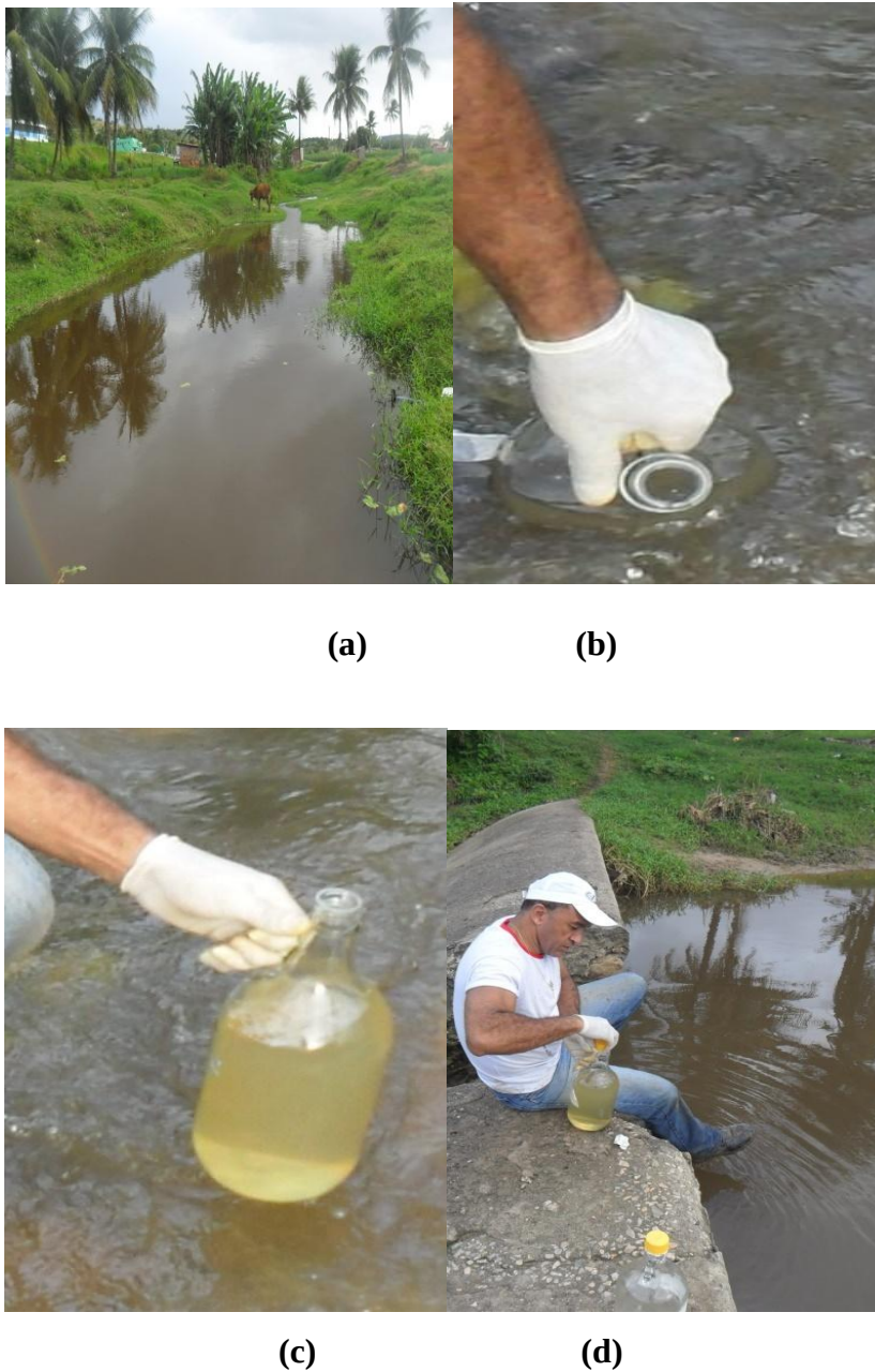
Figura 20 –Sequência de coleta de água do Riacho Natuba: trecho do Riacho que corta a área de estudo (a) introdução do recipiente da coleta no ponto de amostragem (b) volume de amostra coletada (c) e vedação do recipiente para refrigeração e transporte (d)
