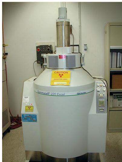
**Figura 3.11** - Irradiador Gammacell 220 EXCEL
