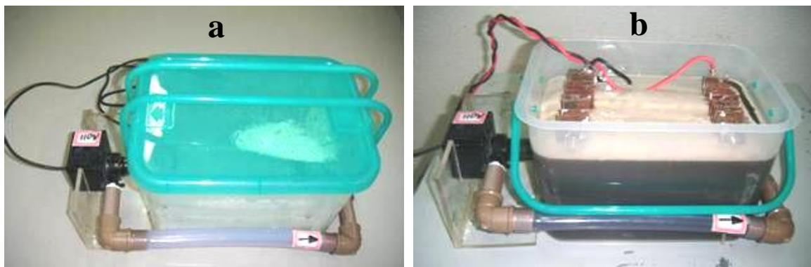
**Figura 3.19** - Fotos do reator eletrolítico vazio (a) e com lixiviado (b)
