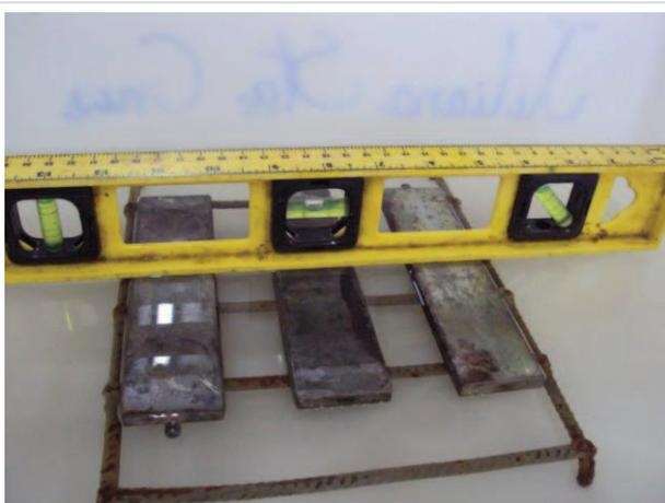
**Figura 6.34** - Corpo de prova teste para conferir a altura da lamina de água
