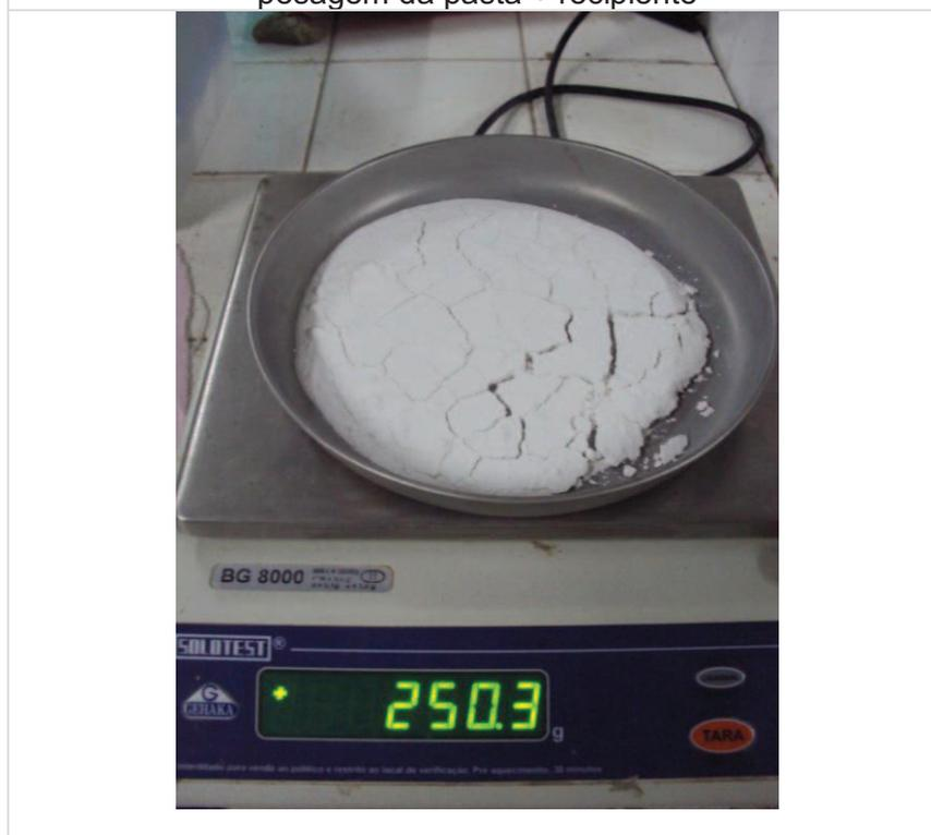
O teste de perda do teor de água se mostrou eficaz no que diz respeito ao procedimento de retirada da água que não estava quimicamente combinada, ou seja, que estava nos poros capilares da pasta e não se combinava com os óxidos de cálcio e magnésio, formando respectivamente os hidróxidos de cálcio e magnésio.
