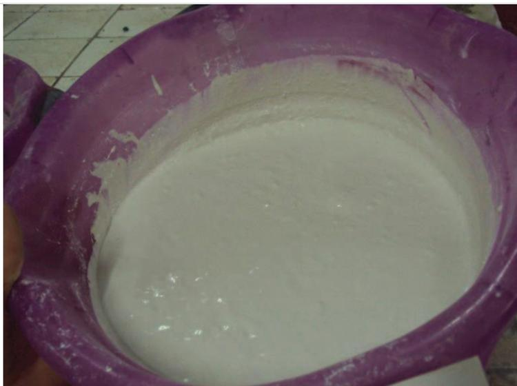
**Figura 6.3** - Teste do teor de água - com consistência mais diluída com nata de água na superfície da pasta
