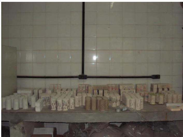
**Figura 6.22 - Retração por secagem dos corpos de prova do traço A**
