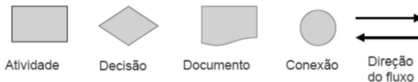
Figura 5.3 – Símbolos para mapeamento do processo
