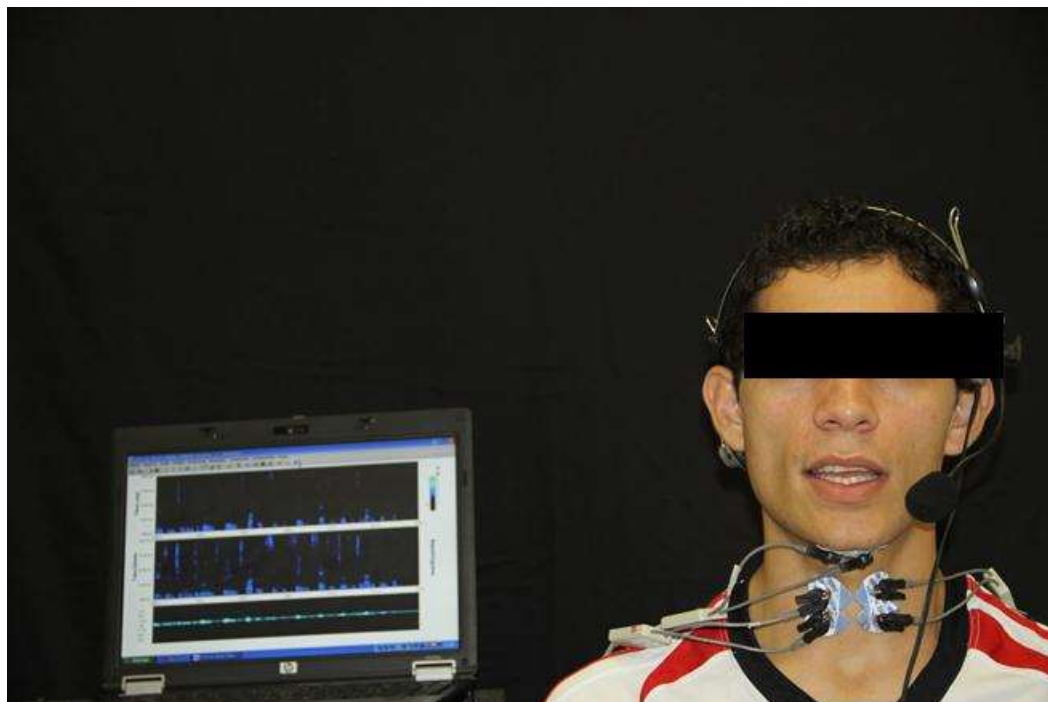
Figura 11 – Posicionamento do sujeito da pesquisa com eletrodos e microfone para gravação da voz
