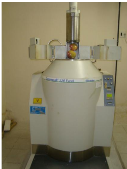
Figura 7 – Irradiador do tipo Gammacell com fonte de ^{60}\text{Co} , modelo 220 Excel_MDS da Nordilon do Departamento de Energia Nuclear (DEN) da UFPE.
