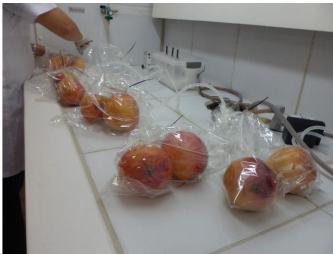
Figura 8 – Extração de voláteis de mangas da cultivar Tommy Atkins mediante o método de headspace dinâmico.
