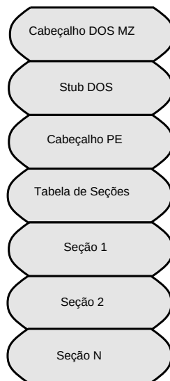
Figura 7.1 Estrutura Básica do Formato PE
