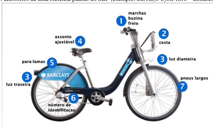
Figura 61: acessórios de uma bicicleta padrão do SBP (exemplo: Barclays Cycle Hire – Londres, Inglaterra).
