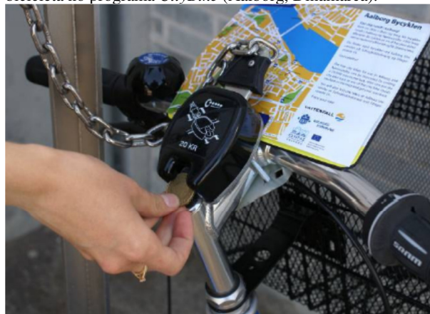
Figura 9: detalhe de colocação da moeda para destravar a bicicleta no programa CityBike (Aalborg, Dinamarca).
