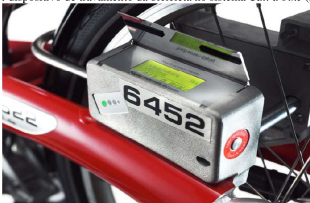
Figura 59: dispositivo de travamento da bicicleta no sistema Call a bike (Alemanha).
