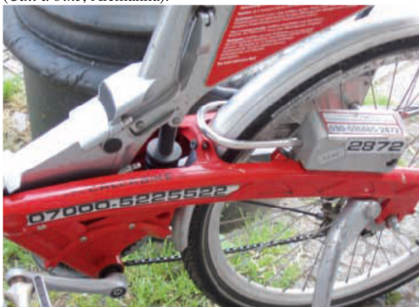
Figura 20: detalhe do mecanismo de desbloqueio da bicicleta ( Call a bike , Alemanha).
