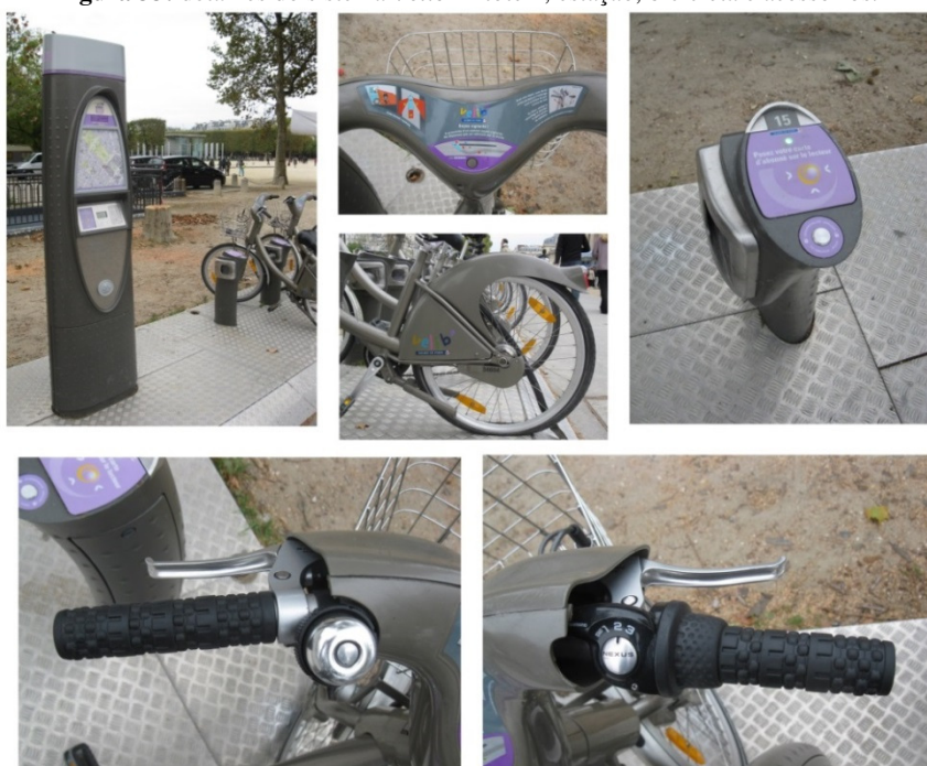
Figura 33: detalhes do sistema Vélib' – totem, estação, bicicleta e acessórios.
