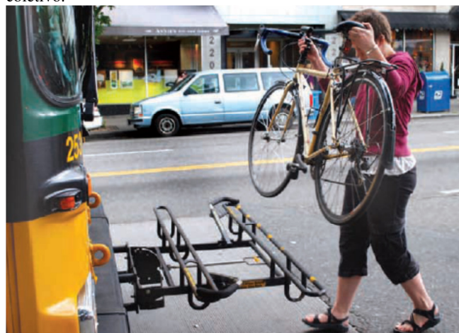
Figura 4: suporte externo para fixação da bicicleta no transporte coletivo.
