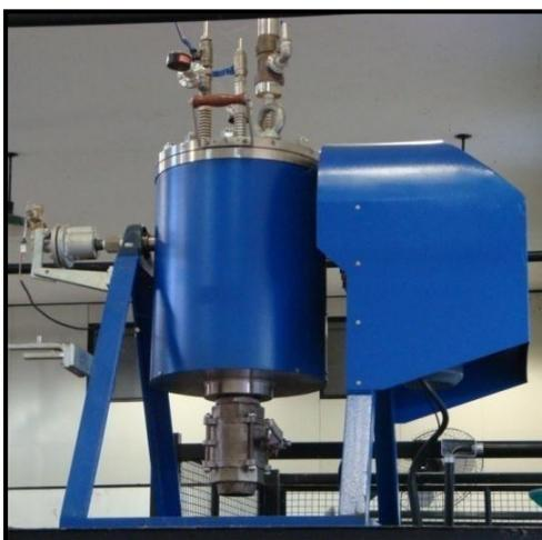
**Figura 4.2** Reator descontínuo (REGMED, AU/E-20) utilizado para obtenção do hidrolisado hemicelulósico de bagaço de cana-de-açúcar.
