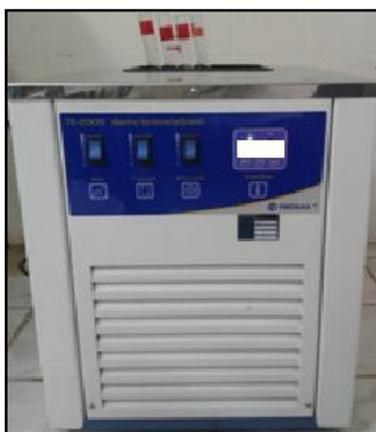
**Figura 4.6** Banho termostático utilizado nos ensaios de atividade enzimática (TECNAL, TE-2005)
