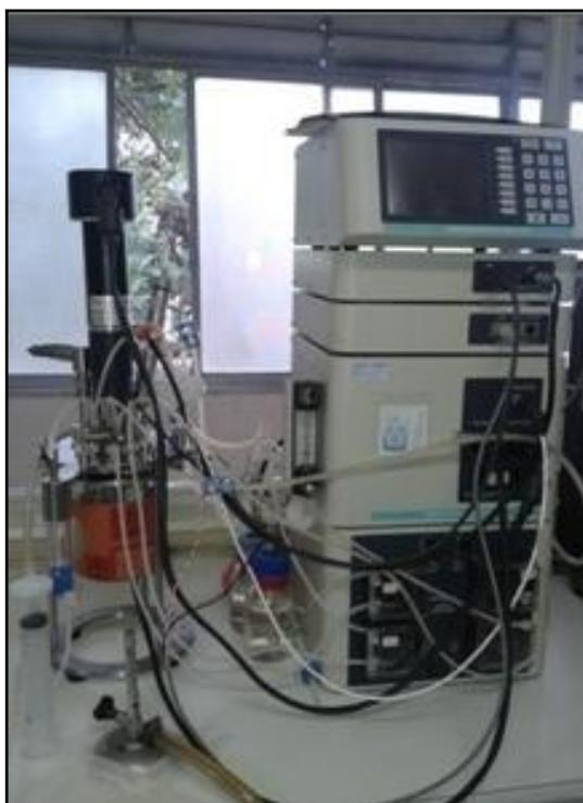
**Figura 4.4** Biorreator de bancada (New Brunswick Scientific, BioFlo 110) utilizado na produção de enzimas.
