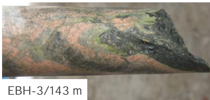
Figura 6.3 – Gnaiss bandado metassomatizado (coloração avermelhada, dada por albitização e presença de microcristais de hematita) com máficos (biotita e hornblenda) alterando para clorita (verde claro). Furo de sondagem EBH-3 (143 m), do depósito de U de São José de Espinharas (PB). A largura do testemunho tem 5 cm.
