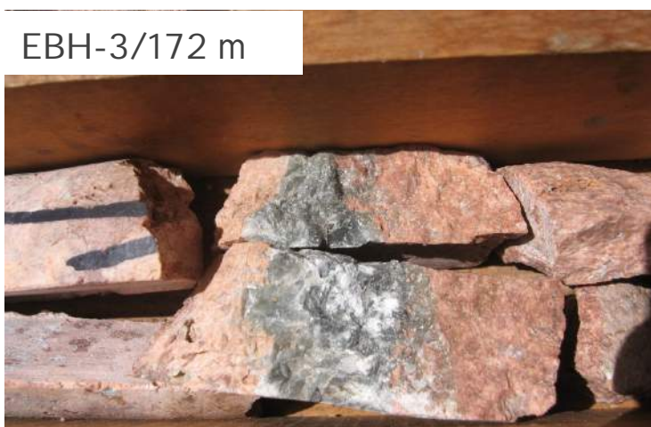
Figura 6.4 – Albitito mineralizado com concentrações anômalas de urânio e veio de quartzo truncado. Furo de sondagem EBH-3 a 172 m. Depósito São José de Espinharas – PB.
