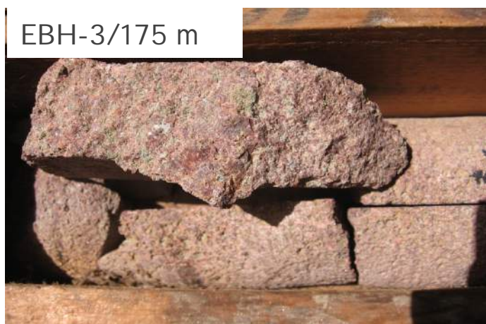
Figura 6.7- Albitito mineralizado com preenchimento de interstícios, possivelmente ricos em clorita (coloração esverdeada), onde se acreditava ser uma potencial fase portadora de urânio e Elementos Terras Rara, furo EBH-3 a 175m.
