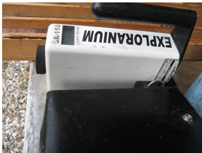
Figura 6.2 – Cintilômetro portátil da marca Explorium Gr-110 Gamma Ray Scintillometer, usado para contagem de radiação total (K + Th + U) por segundo (cps).
