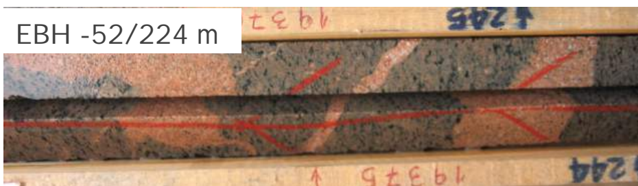
Figura 6.6 – Diques e apofises graníticos epissieníticos (albitito avermelhado) cortando o gnaiss (cinza avermelhado). EBH-52 a 224m. Depósito São José de Espinharas – PB.
