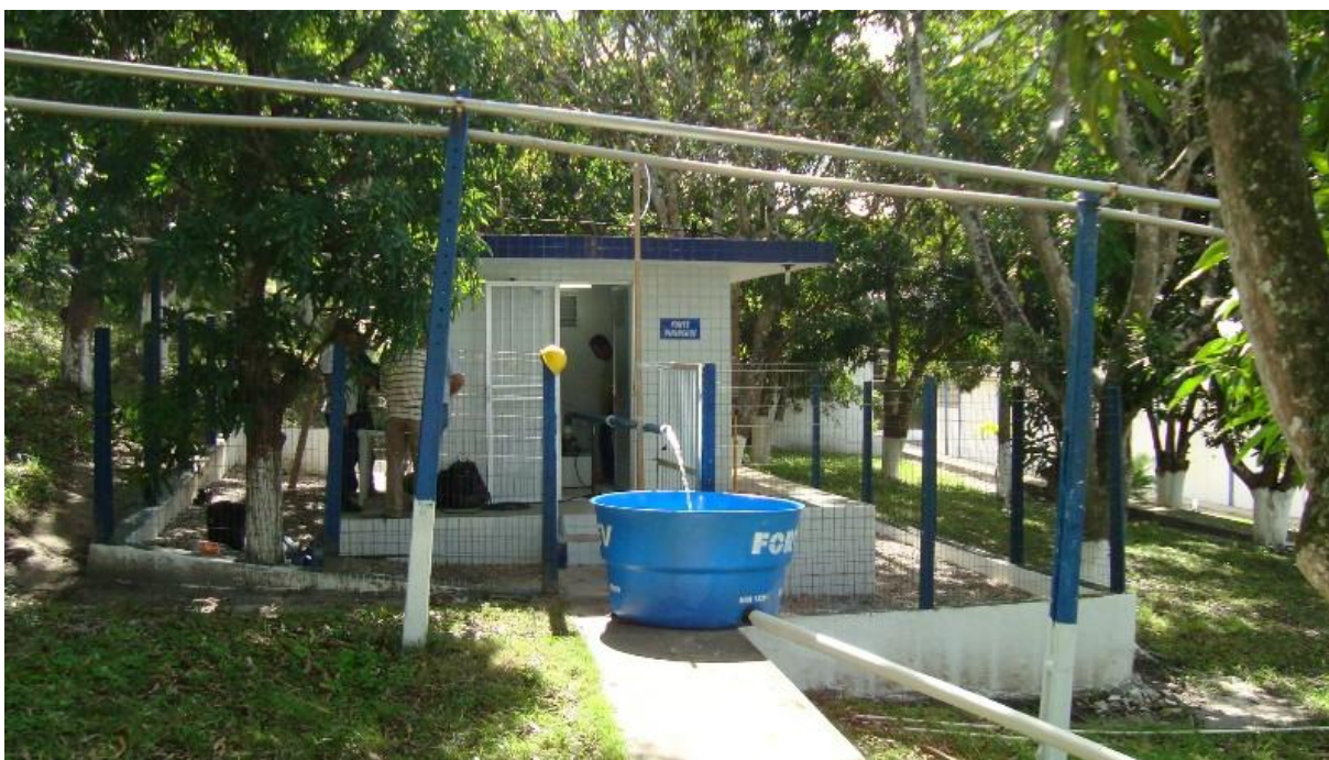
Figura 4.28 Escoamento da água do poço PII- Pininchos de Mumbaba para o córrego. A foto também mostra o tambor de fibra para recepção imediata da água, e que não oferece nenhuma resistência ao deslocamento primário do bombeamento, e a tubulação de 100mm para o transporte.
