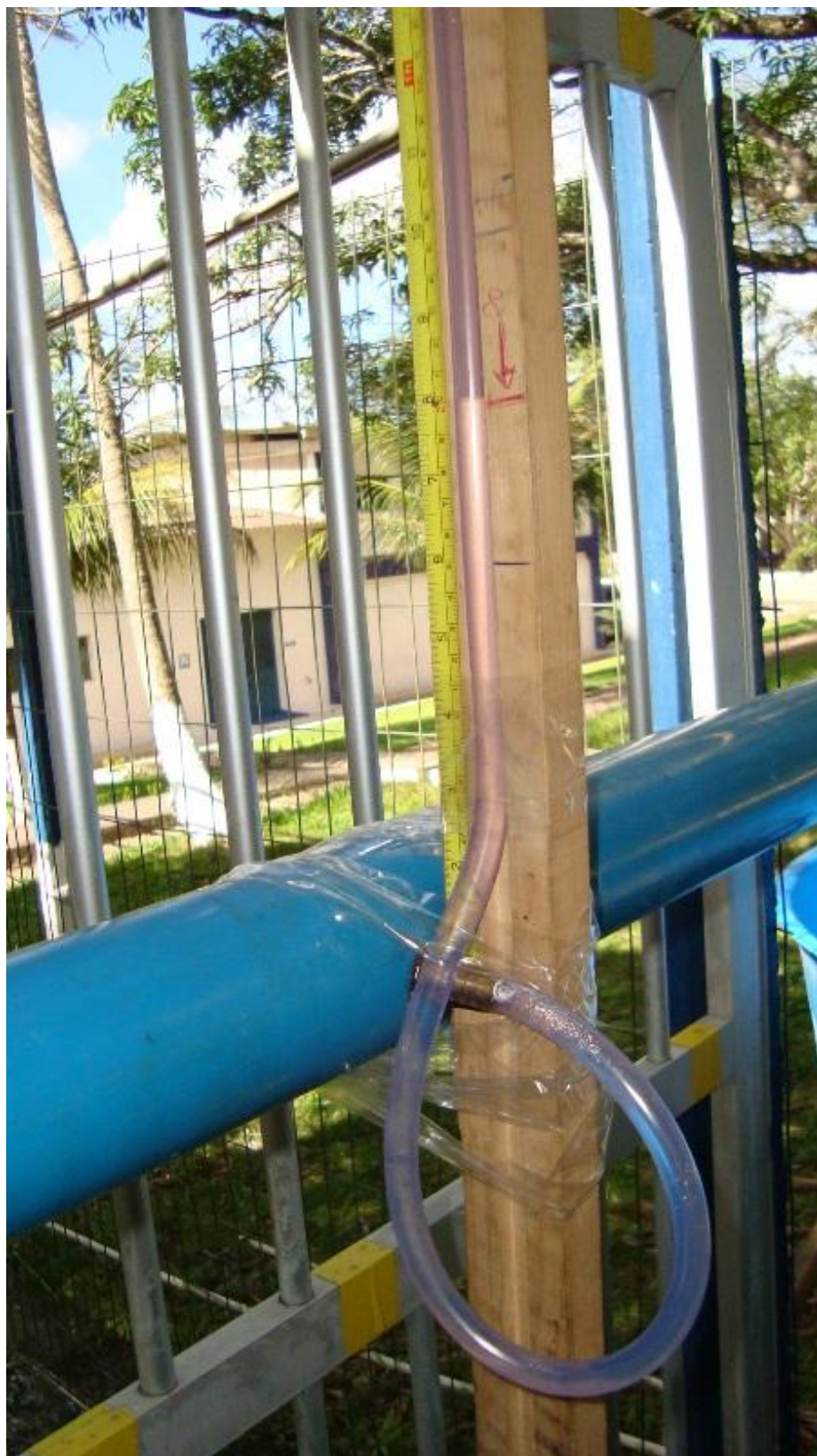
Figura 4.29 Marcação da altura piezométrica na mangueira calibrada pela trena afixada à régua de madeira.
