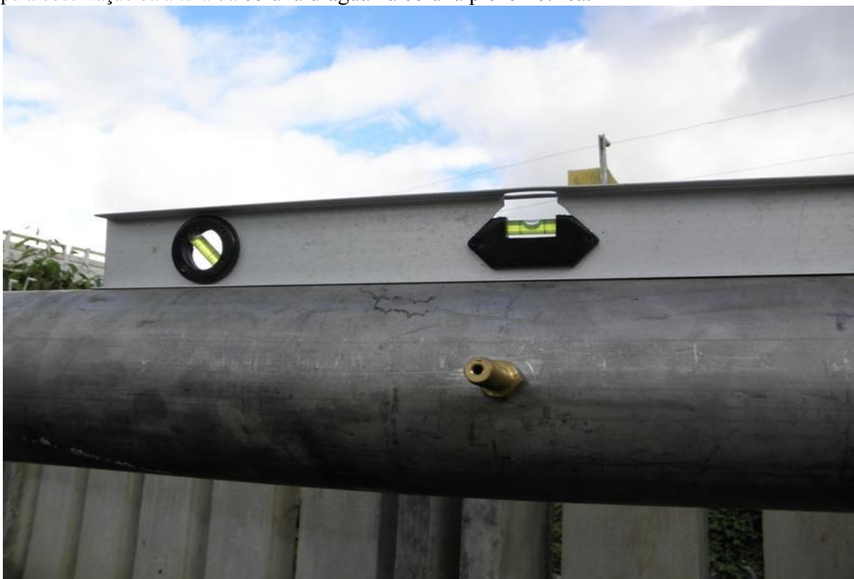
Figura 4.13 Nivelamento do escadouro de orifício circular.
