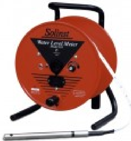
Figura 4.2 Medidor de nível elétrico, que funciona pelo disparo de aviso sonoro e luminoso ao entrar em contato com a água.
