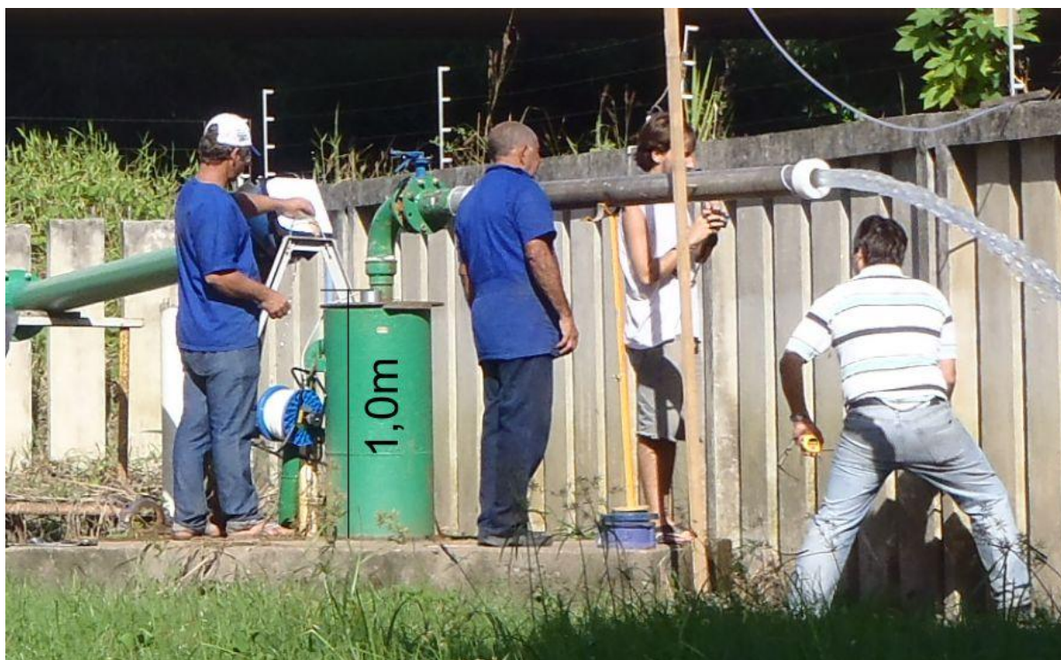
Figura 4.9 Detalhe do poço de produção P3 e do escoadouro de orifício circular em aço inox. Pode-se observar o orifício menor na sua extremidade de cor branca em nylon, sendo fabricados exclusivamente para esse teste no torno mecânico.
