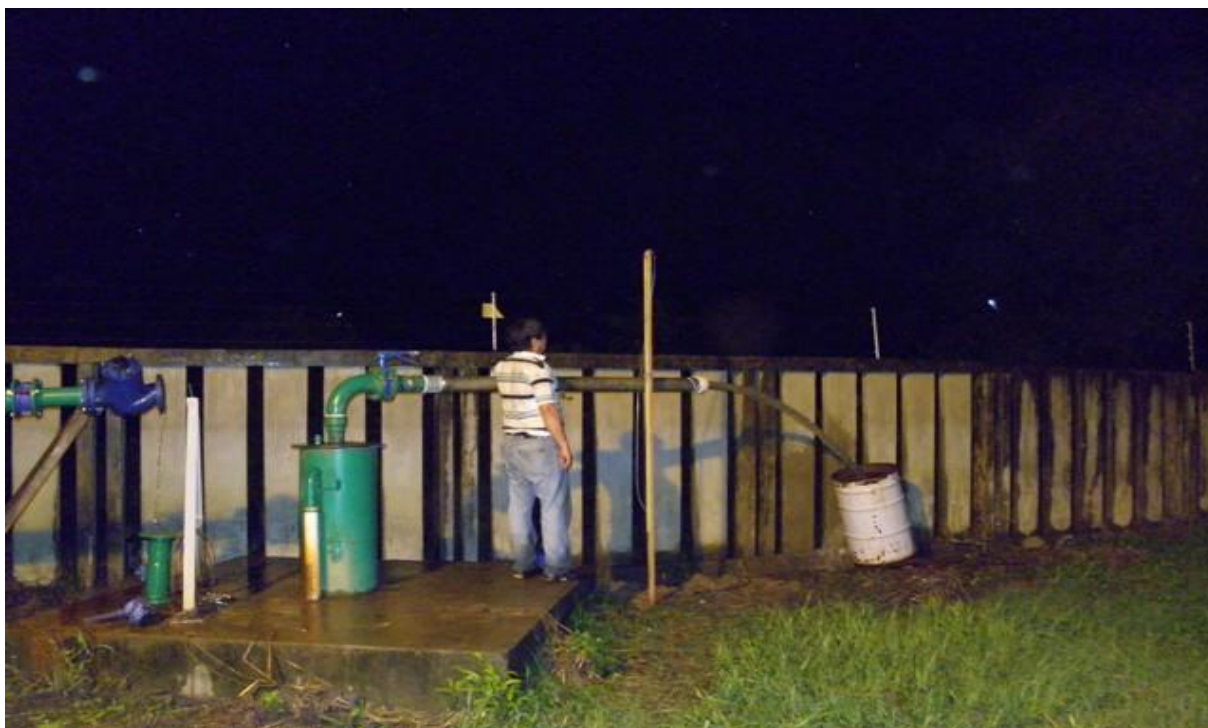
Figura 4.12 Monitoramento noturno para observação da altura piezométrica da coluna de água e da vazão. O controle da vazão foi realizado através do registro cuja graduação de abertura é fornecida pela observação da altura da coluna d'água na coluna piezométrica.
