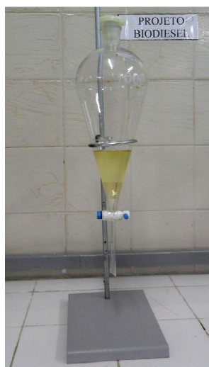
Figura 9 -Processo de decantação do glicerina. Separação das fases óleo/alcool e glicerina.
