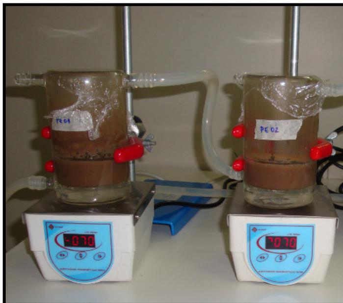
**Figura 3.7** – Hidrólise enzimática realizada em minirreatores encamisados.
