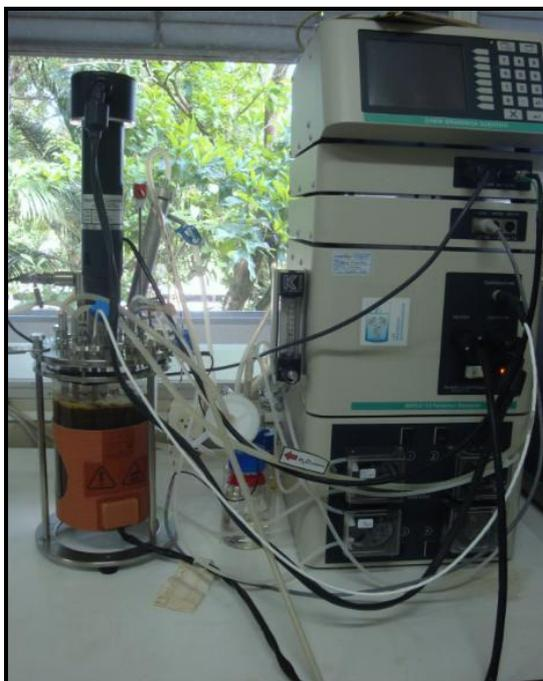
**Figura 3.6** - Biorreator de bancada instrumentado (New Brunswick Scientific, Bioflo 110) utilizado na produção de enzimas.
