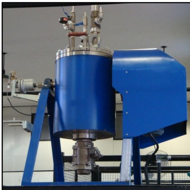
**Figura 3.1** - Reator de 20 L (Regmed, AU/E-20), utilizado nos experimentos de pré-tratamento de bagaço de cana-de-açúcar.
