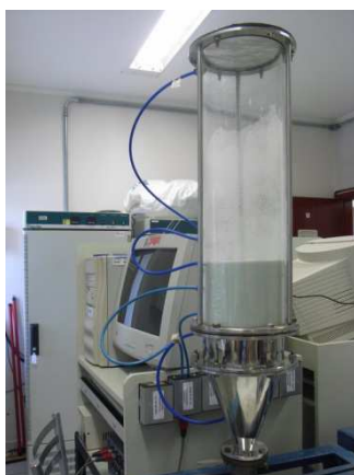
FIGURA 5. REATOR DO TIPO LEITO FLUIDIZADO (FFB)
