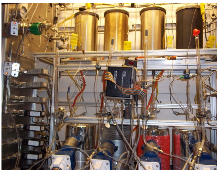
Figura 3.3: Detalhe do sistema de multi reatores para avaliação catalítica
