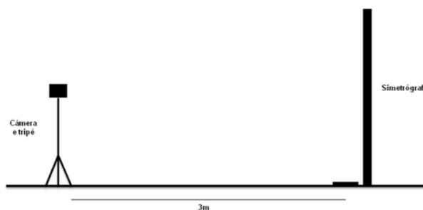
**Figura 2.** Desenho esquemático do posicionamento da câmera e do simetrógrafo.
