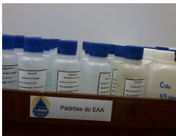
Figura 7 - Padrões dos minerais e metais pesados utilizados para determinação da curva
