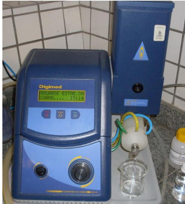
**Figura 13. Fotômetro de chama utilizado para determinações de potássio.**
