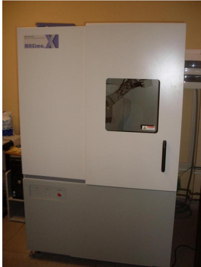
**Figura 10. Difratorômetro de raios-X utilizado na análise mineralógica**
