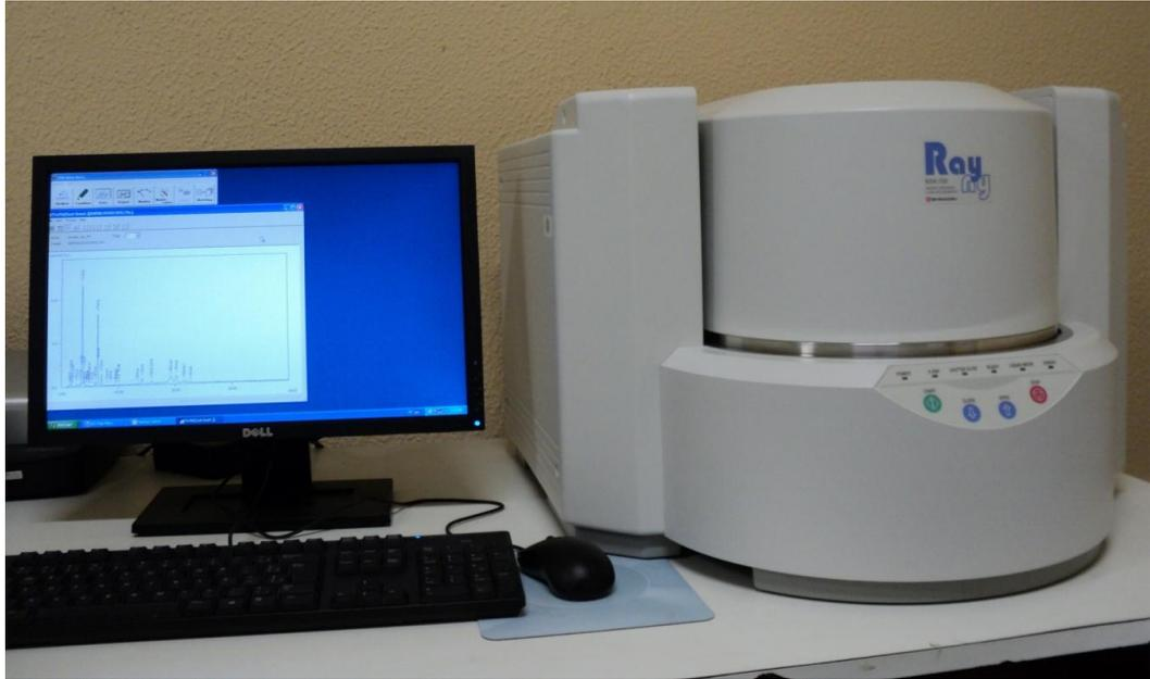
**Figura 9. Espectrômetro de fluorescência de raios-x utilizado na análise química.**
