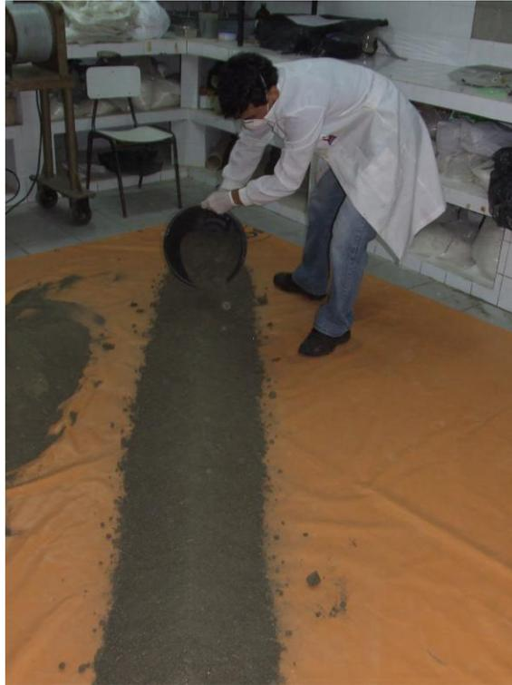
**Figura 7. Pilha de homogeneização da amostra de rejeito de vermiculita.**
