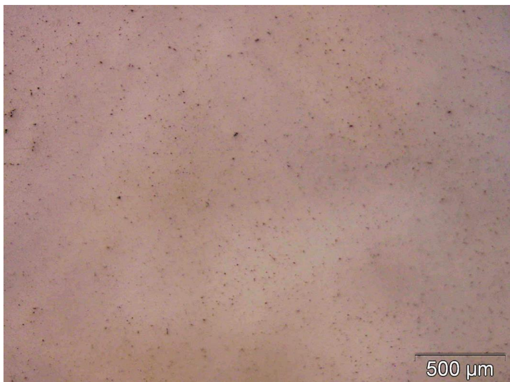
Figura 4.55 – Aço rápido AISI M3:2 com a adição de carboneto de nióbio (NbC) – Ataque químico Nital a 3%
