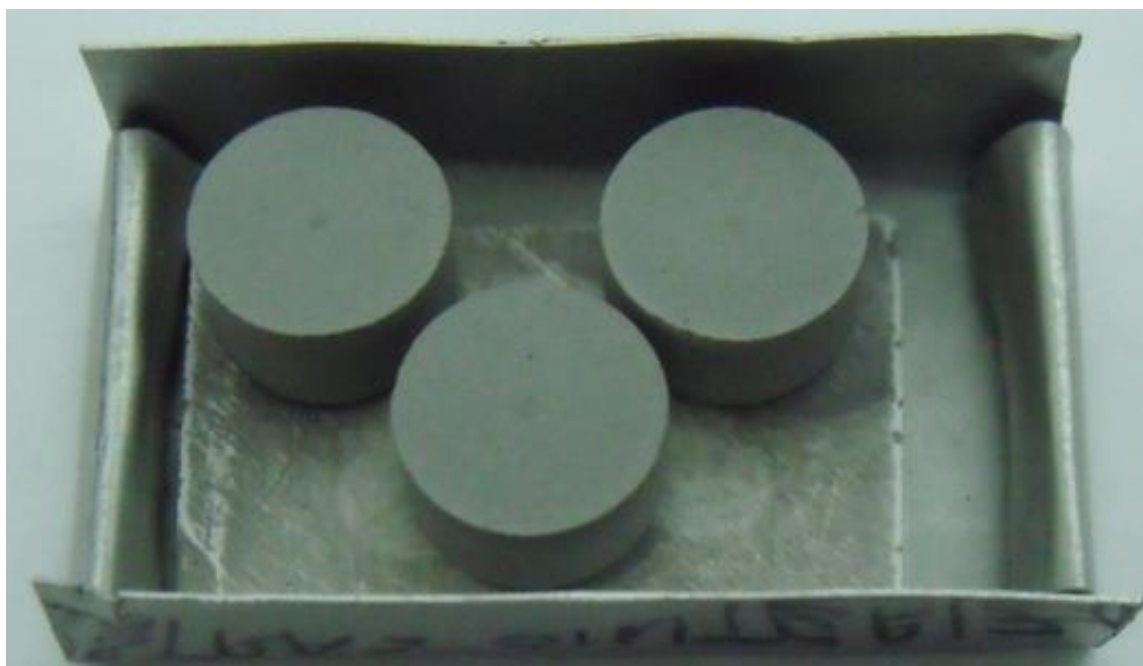
Figura 4.38 – Pastilhas sinterizadas do aço rápido AISI M3:2 com adição de carboneto de nióbio (NbC)
