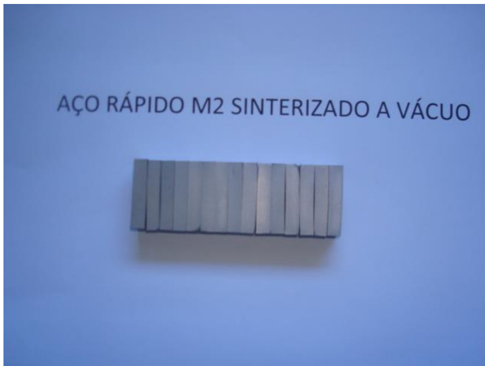
Figura 4.33 – Pastilhas do aço rápido M2 sem reforço de NbC sinterizado a vácuo
