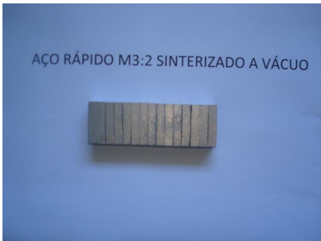
Figura 4.34 – Pastilhas do aço rápido M3:2 sem reforço de NbC sinterizado a vácuo
