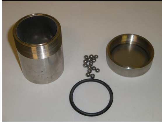
Figura 3.1 - Jarra tampa anel de vedação de borracha e bolas
