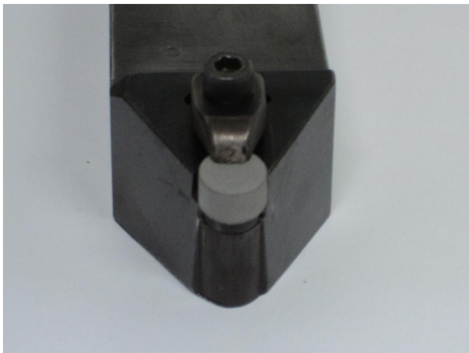
Figura 4.43 - Pastilha do aço rápido AISI M2 fixada ao suporte
