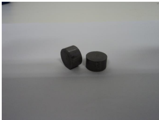
Figura 3.3 - Vistas superior e lateral do compactado verde
