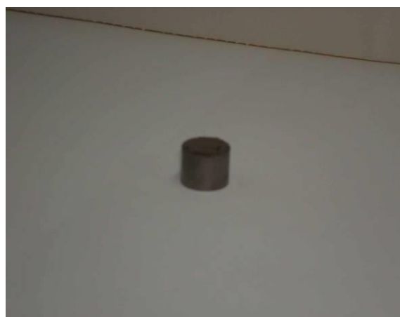
Figura 4.32 – Compactado a partir do pó de M2 + NbC e M3:2 + NbC processados no moinho SPEX
