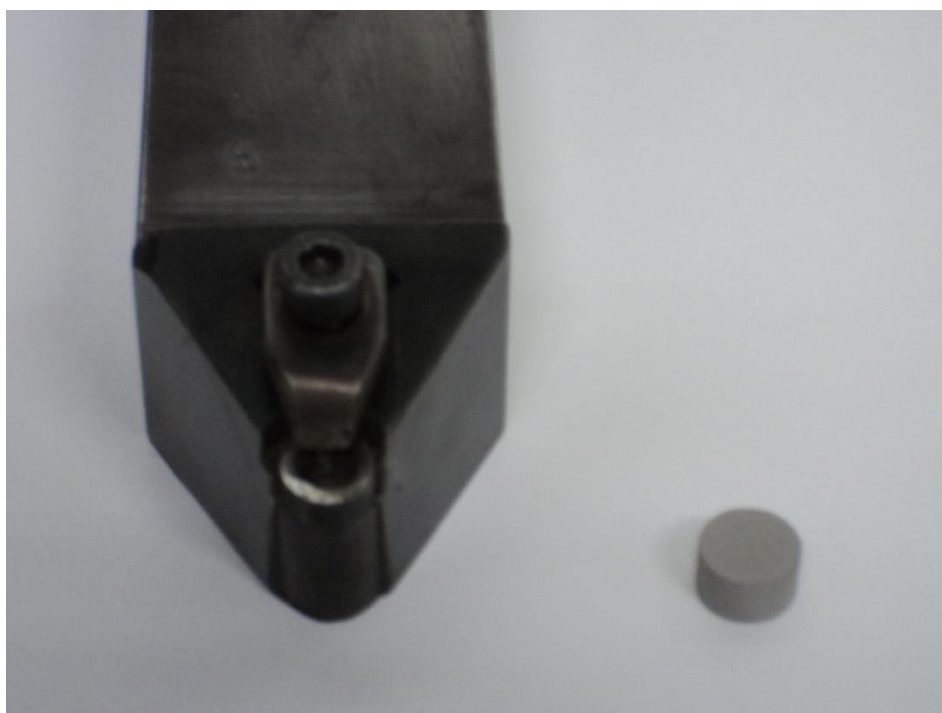
Figura 4.42 – Pastilha do aço rápido AISI M2 com o suporte
