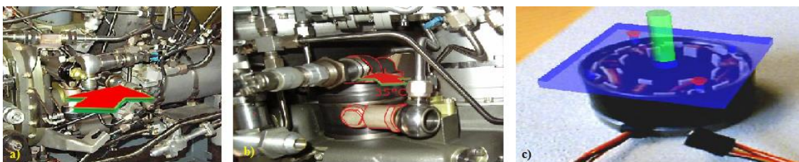
Figura 3.9: Exemplo de algumas funções do T.A.C. Da esquerda para a direita: Picking (a), Outlining (b) e Adding (c) (Bottecchia; Cieutat; Jessel, 2010).
