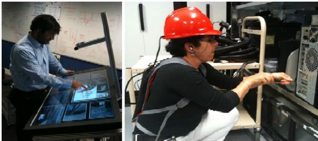
Figura 3.10: Estrutura do ReMoTe. À esquerda, a interface do especialista e à direita os componentes do técnico (Alem; Tecchia; Huang, 2011).
