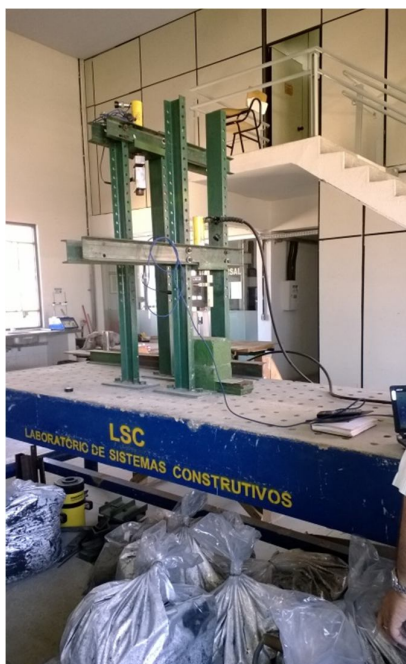
Figura 14 – Prensa hidráulica utilizada para os ensaios de energia e compactação e moldagem dos corpos-de-prova sob pressão.
