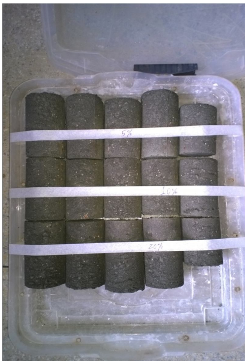
Figura 18 – Corpos-de-prova moldados para os ensaios . Fonte: o autor.
