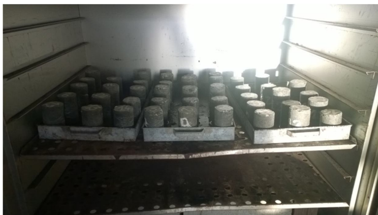
Figura 20 – Estufa onde foram mantidas os corpos-de-prova durante os ensaios de absorção. Fonte: o autor.
