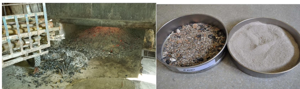
Figura 17 – Tratamento do cinza de Algaroba, através de peneiramento. Fonte: (LELOUP, 2013)
