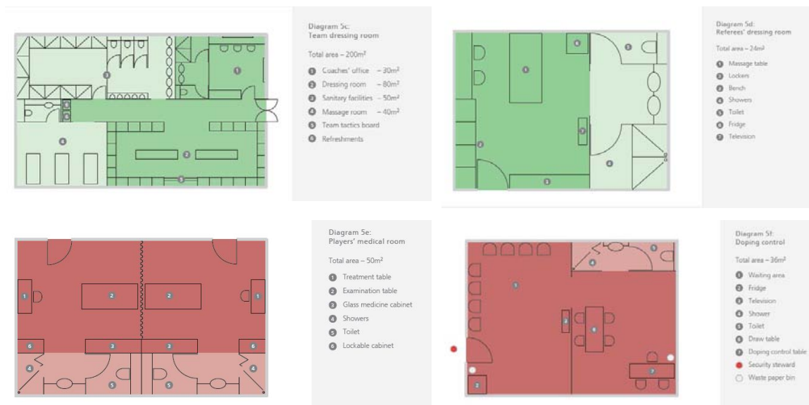
Figura 39 – indicações de leiaute para organização espacial dos ambientes de vestiários (superior esquerda), sala de árbitros (superior direita), atendimento médico (inferior esquerda) e controle de doping (inferior direita) (fonte: FIFA, 2011, p. 98; 102; 104)
