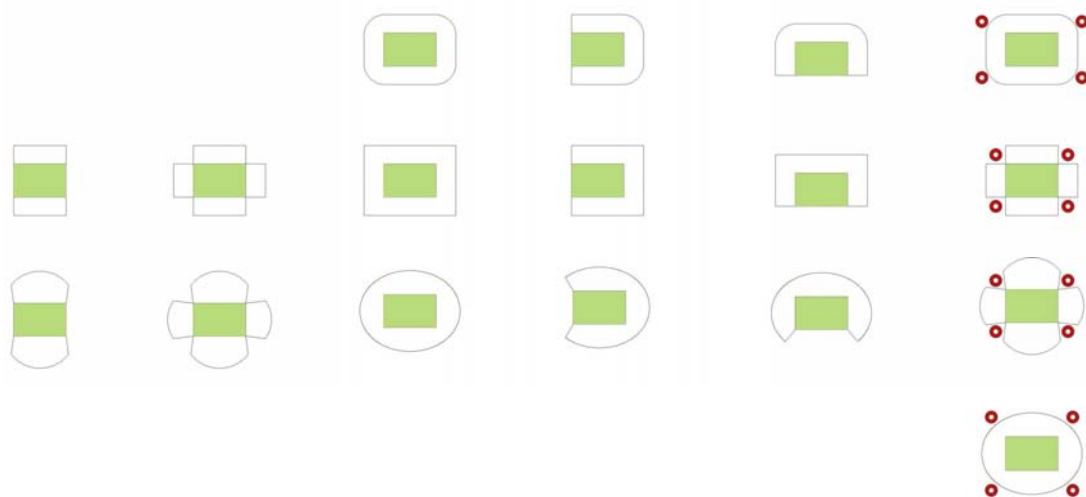
Figura 77 – representação previsiva das possíveis variações na geometria da planimetria horizontal dos estádios contemporâneos a partir da organização dos setores de arquibancadas e das circulações verticais (círculos em vermelho, nos exemplos mais à direita) (desenhos do autor).
