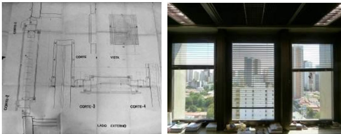
Figura 82 - Detalhe da esquadria
