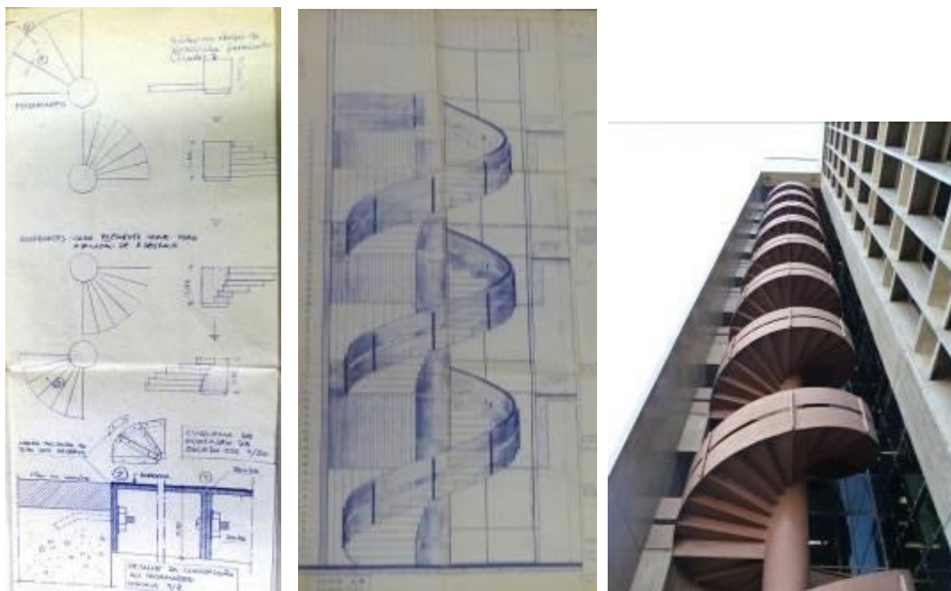
Figura 83 - Projeto e imagem da escada de incêndio
