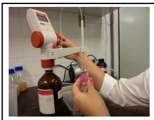
FIGURA 3. Amostra da titulação com NaOH e HCl a 0,025 M, com o auxílio de uma bureta automática marca Aptilab.
