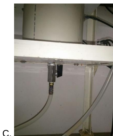
Figura 21. A. Gás metano; B. Rotâmetro para controle de fluxo de entrada; C. Entrada do gás (base da coluna); D. Saída do gás (topo da coluna)
