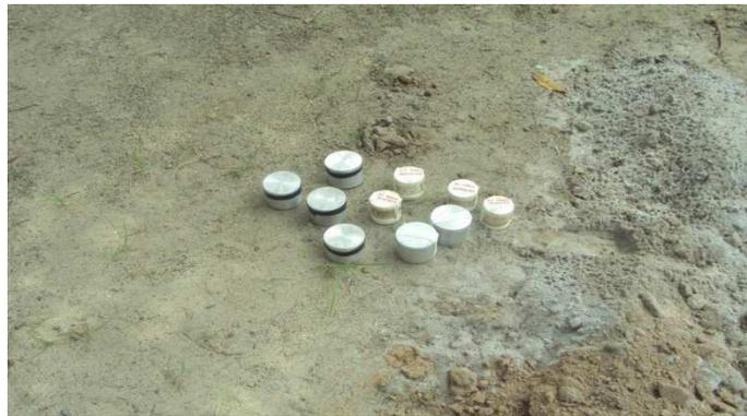
Figura 8 - Coleta de amostra para densidade dos solos
