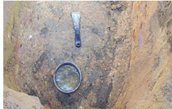
Figura 14 - Ensaio de infiltração à superfície    Figura 15 - Ensaio de infiltração à 20 cm
