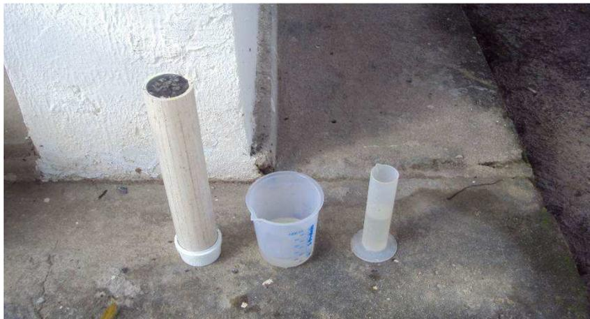
Figura 10 - Determinação da porosidade da brita
