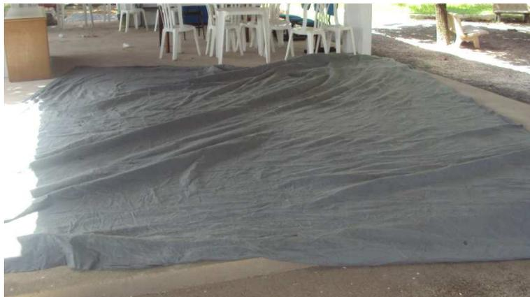
Figura 17 - Manta Geotêxtil Bidim RT-08 utilizada na trincheira de infiltração
