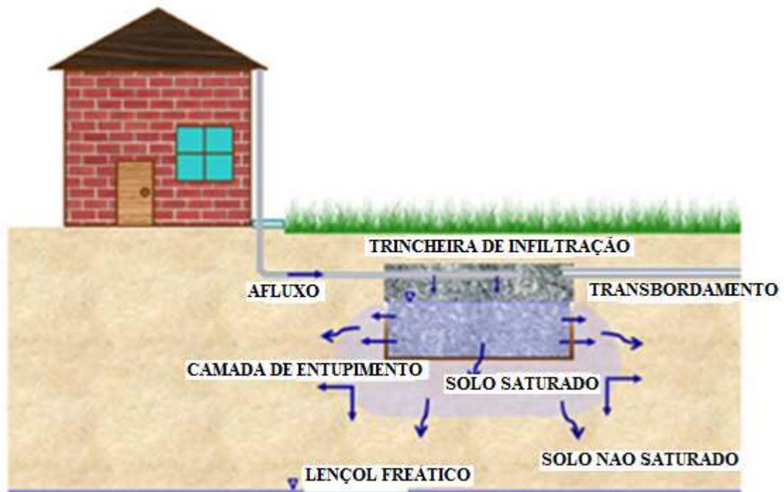
Figura 1 - Trincheira de infiltração
