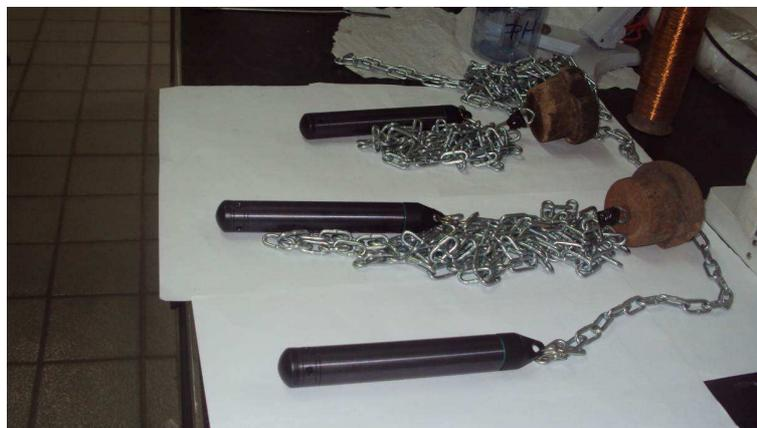
Figura 24 – Sensores de níveis usados no monitoramento.
