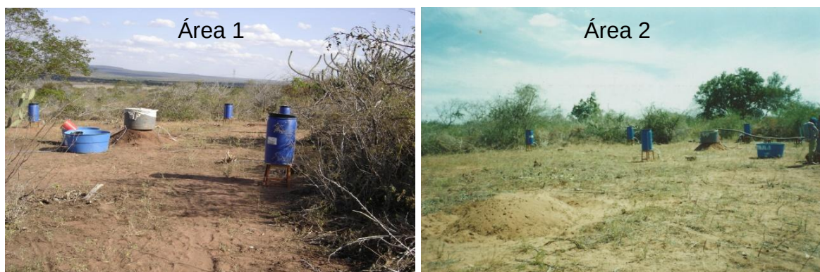
Figura 3.5 - Paisagem das áreas 1 e 2 com os infiltrômetros instalados para ensaios de infiltração na localidade do Jusante, Glória - BA.
