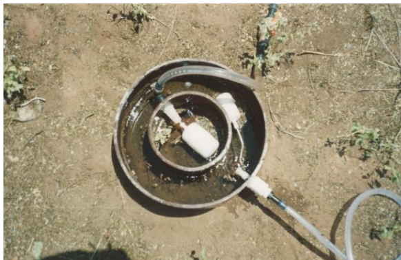
Figura 3.3 - Infiltrômetro duplo anel com sistema automático de recarga de água para abastecimento
