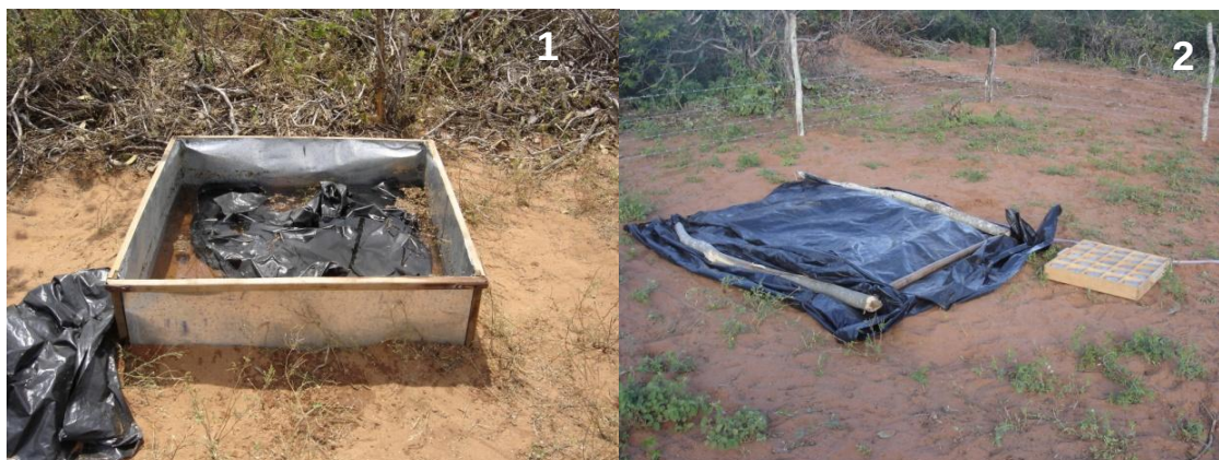
Figura 3.6 - Teste de capacidade de campo: (1) grade retentora de água e (2) grade coberta por lona plástica e conjunto de latas para armazenar amostras de solos
