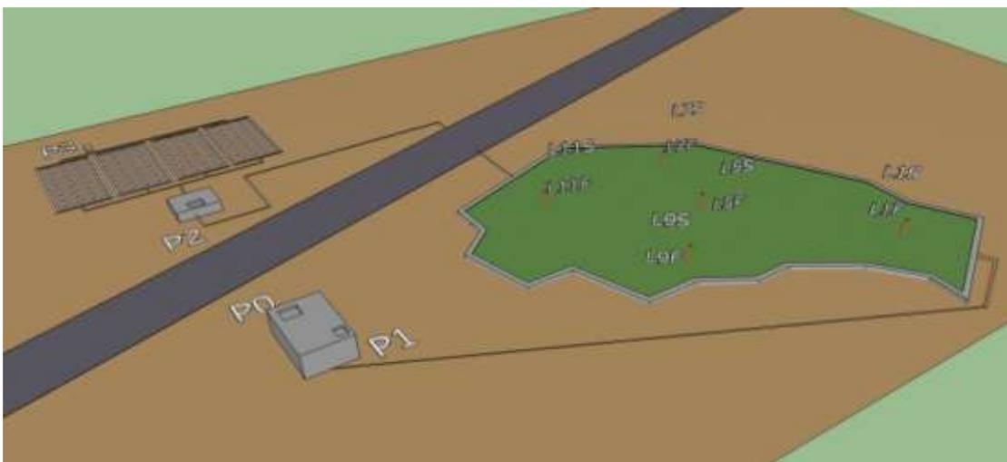
**Figura 5** - Desenho esquemático da ETE- Rio Formoso demonstrando os pontos de coleta no sistema. P<sub>0</sub>- Afluente da ETE (esgoto bruto) P<sub>1</sub>- Efluente dos reatores UASB, P<sub>2</sub>- Efluente da lagoa de polimento, P<sub>3</sub>- Efluente dos filtros de pedra (efluente final).
