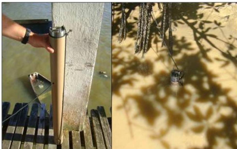
Figura 7. Sensores de pressão utilizados na obtenção dos registros de variação de nível.
