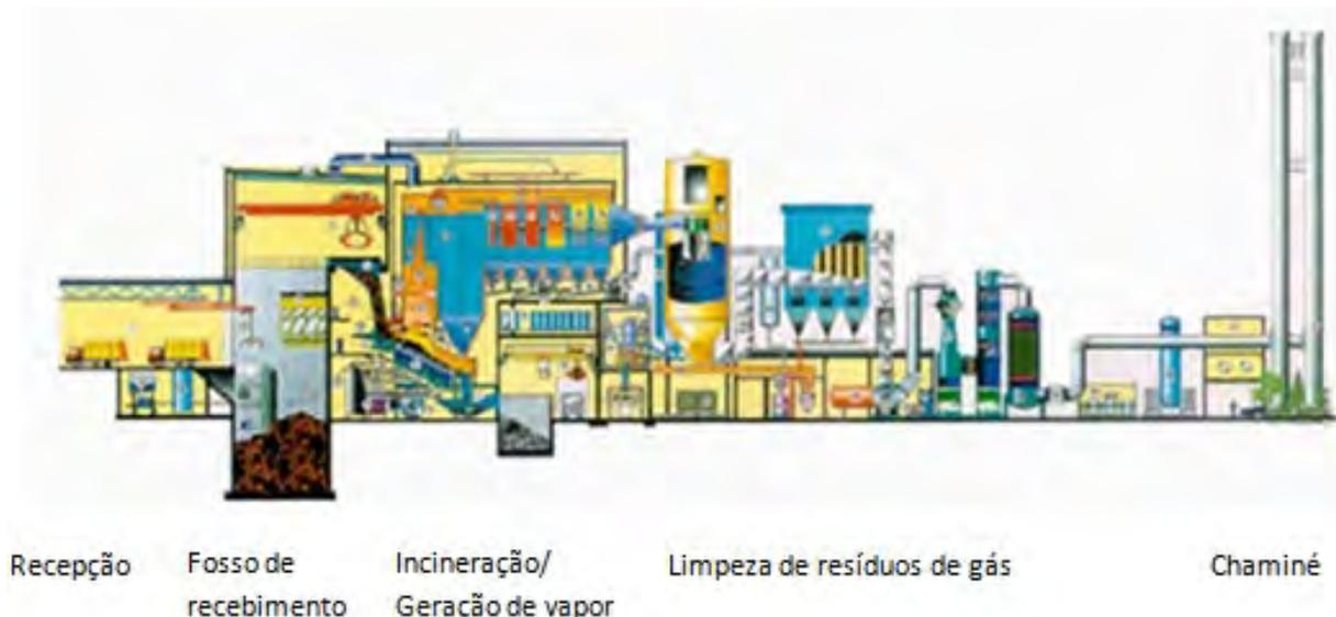
Figura 2.7 - Planta típica de incineração de resíduos.
