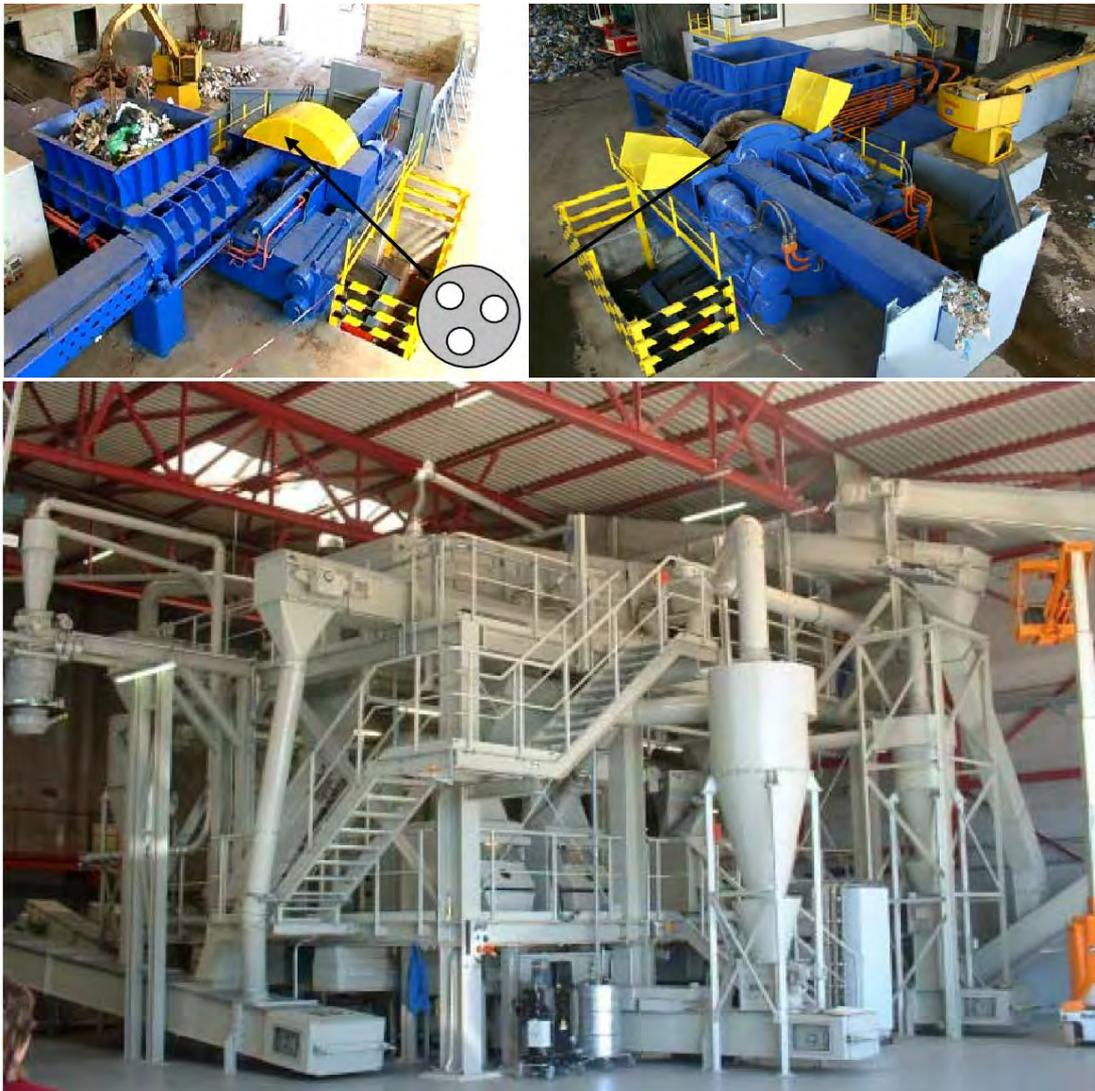
Figura 2.5 – Planta de TMB com seu processo de separação de RSU.
