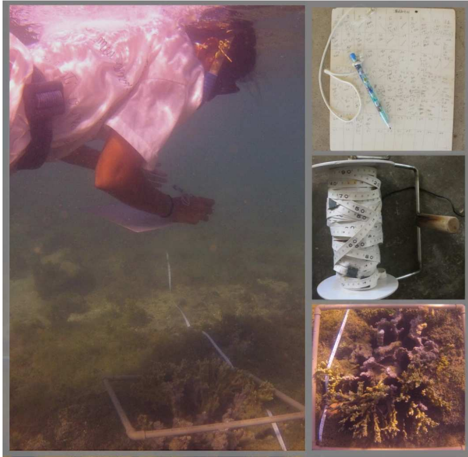
Figure 3: Metodologia de linhas de transectos e quadrats adotada para a análise de densidade populacional de ouriços e corais nos dois recifes estudados.
