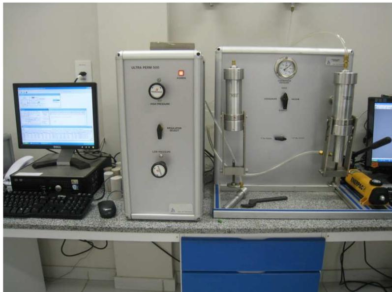
Figura 15 - Permeabilímetro a gás nitrogênio. Foto da autora.
