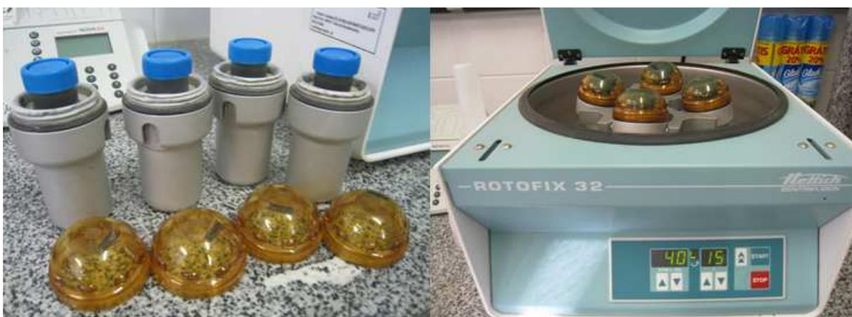
Figura 9 - Preparação das amostras para determinação de sólidos suspensos. Foto da autora.
