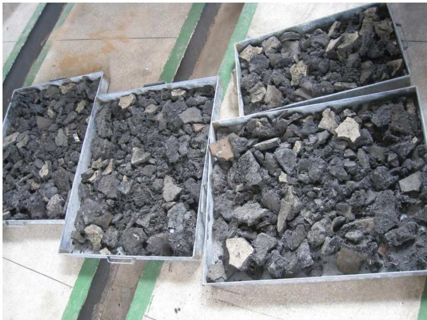
Figura 6 - Lodo têxtil após secagem em estufa. Foto da autora.
