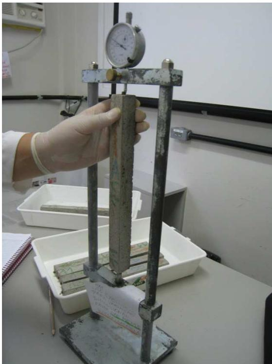
Figura 13 - Aparelho comparador de comprimento. Foto da autora.
