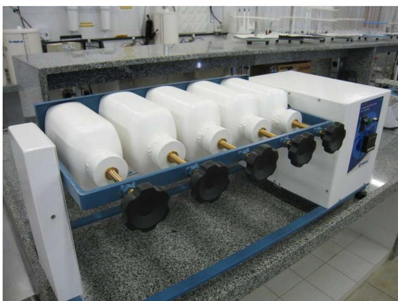
Figura 10 - Agitador rotativo para lixiviação. Foto da autora.
