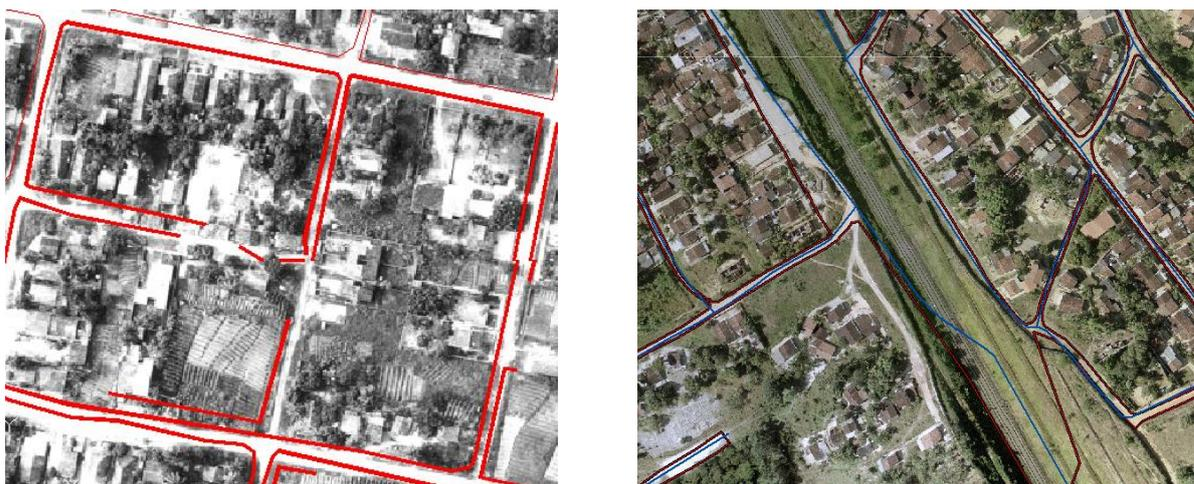
Figura 31 - Erros grosseiros identificados nos vetores que representam a feição de planimetria. À esquerda o vetor de planimetria do CACI datado de 1997 e à direita o vetor de planimetria da PCR datada de 2007.
