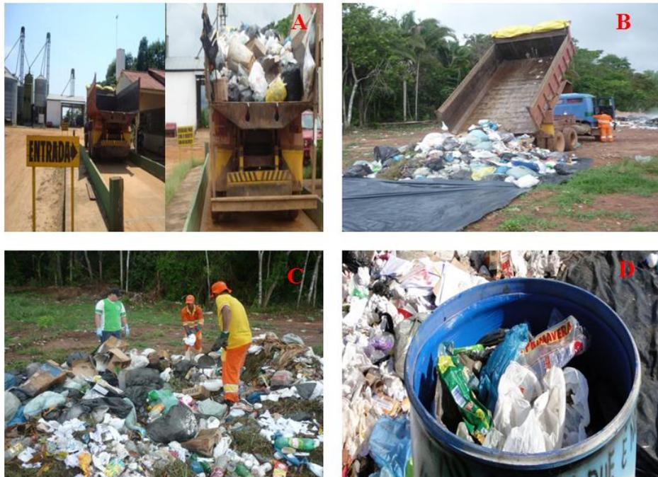
**Legenda:** A) Pesagem do caminhão vazio e com RSU. B) Descarregamento dos resíduos sólidos na lona. C) Reviramento dos resíduos sólidos para o quarteamento. D) Após o procedimento do quarteamento dos resíduos foi realizado a segregação dos materiais para determinar da composição gravimétrica.
