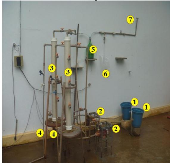
**Legenda:** 1- Entrada do afluente no sistema; 2 - Bomba centrífuga utilizada para recirculação do lixiviado; 3 - Reatores anaeróbios UASB; 4 - Saída do efluente tratado; 5 - Medidor de gás; 6 - Reservatório de biogás; 7 - Saída do biogás excedente.
