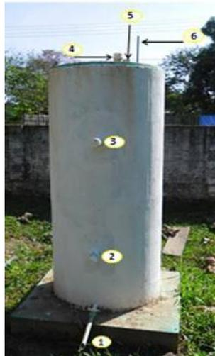
**Legenda:** 1. Tubo de drenagem, 2 e 3 Tubo de coleta de sólidos, 4. Dreno de gás, 5. Piezômetro, 6. Placa de recalque.
