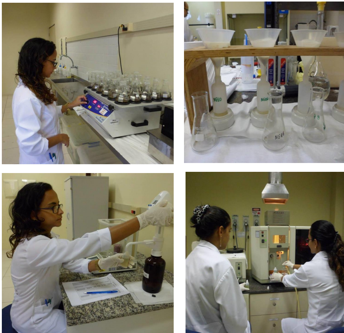
Figura 12: Obtenção das concentrações potencialmente biodisponíveis. (a) lixiviação do sedimento com HCl por 1 hora. (b) lixiviados sendo filtrados, transferidos para um frasco de polietileno, (c) concentrado sendo avolumados até aproximadamente 50 mL com HNO 3 a 2% e (d) aquisição das concentrações pela técnica de espectrometria de absorção atômica por chama (FAAS).
