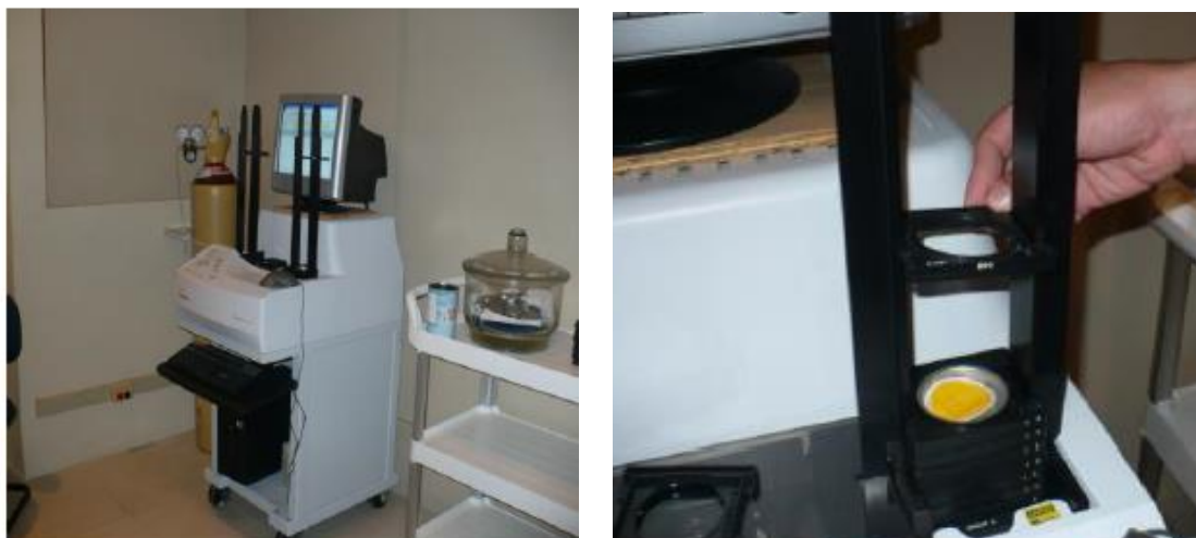
Figura 11: Equipamento para medida de partículas alfa e beta (Detector Proporcional de Fluxo Gasoso - marca Canberra modelo S5 XLB); (a) Visão geral do detector \alpha , \beta e (b) Detalhe de colocação das amostras para leitura. (Fonte: Arruda, 2010).
