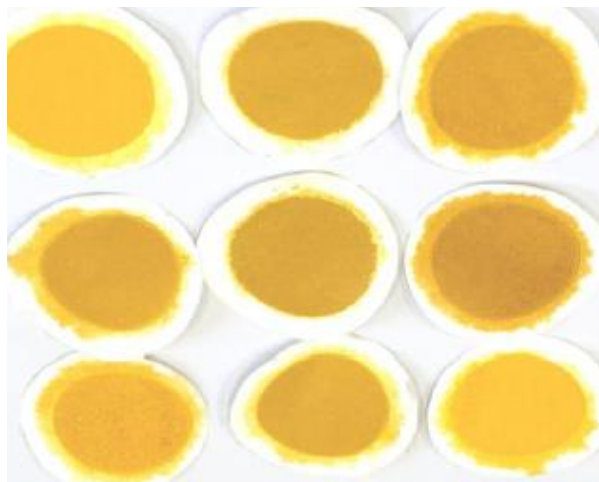
Figura 10: Precipitado de ^{210}\text{Pb} filtrado em papel Millipore.
