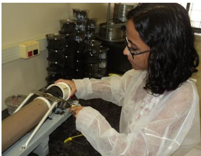
Figura 8: Testemunhos ainda congelados, sendo retirados dos tubos e seccionados a cada três centímetros.
