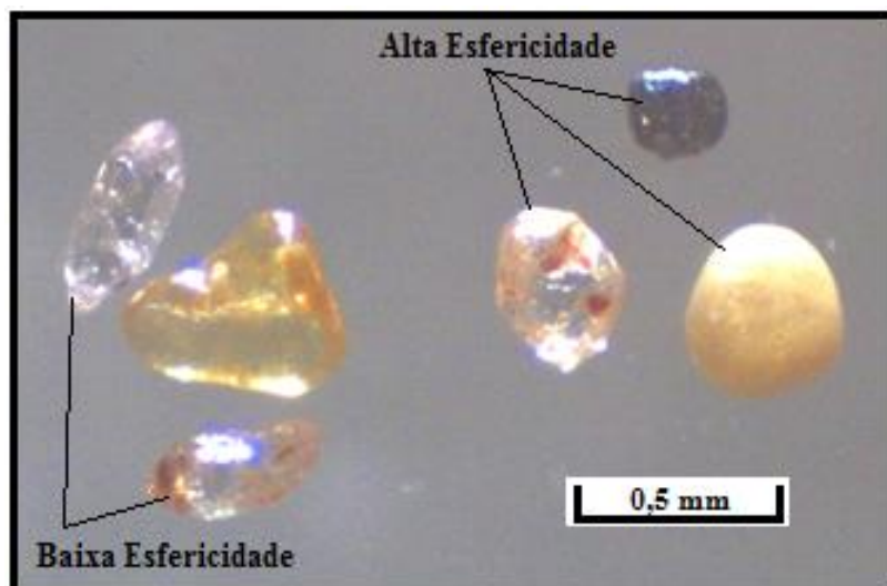
Figura 48: Exemplo de grãos com alta e baixa esfericidade.
