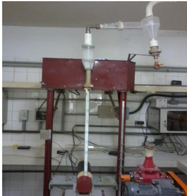
**Figura 3.5:** Imagem do sistema detecção por raios gama no reator de leito fluidizado borbulhante.
