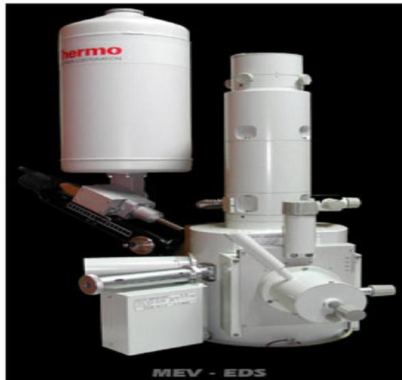
**Figura 3.1:** Imagem de um sistema MEV-EDS.
